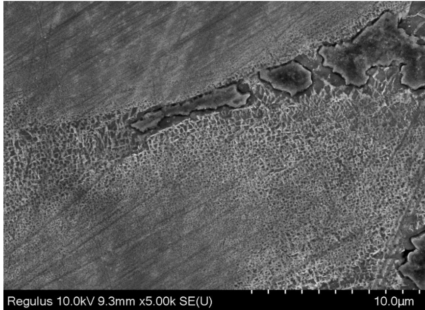
Şekil 5.7. TMS-238 alaşımının döküm halinde tane sınırının 10kV’da ikincil elektron TEM görüntüsü (5000x)
