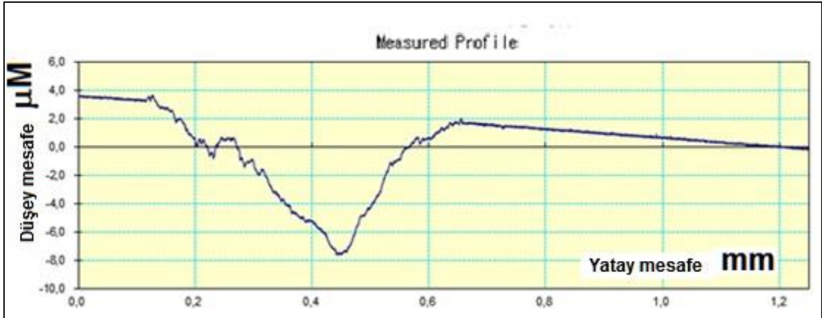
Şekil 4.30. 30 numaralı numunenin (%0,5 B) aşınma test grafiği
