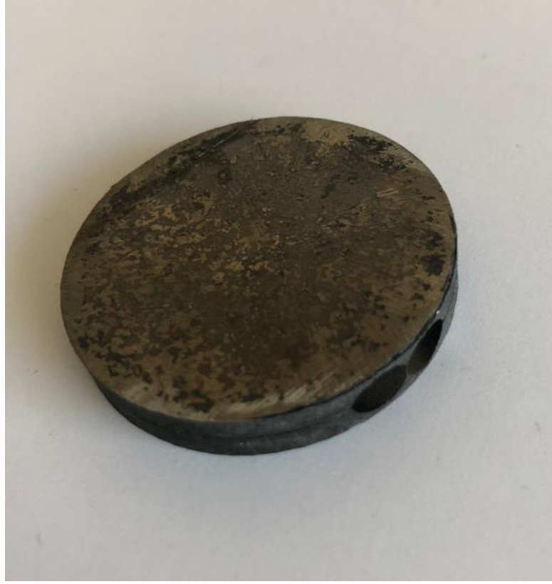
Şekil 4.41. 40 mm çapında, SPS yöntemi ile üretilmiş disk. Tel erozyon yöntemi ile silindirik parçalar çıkarılmış hali.
