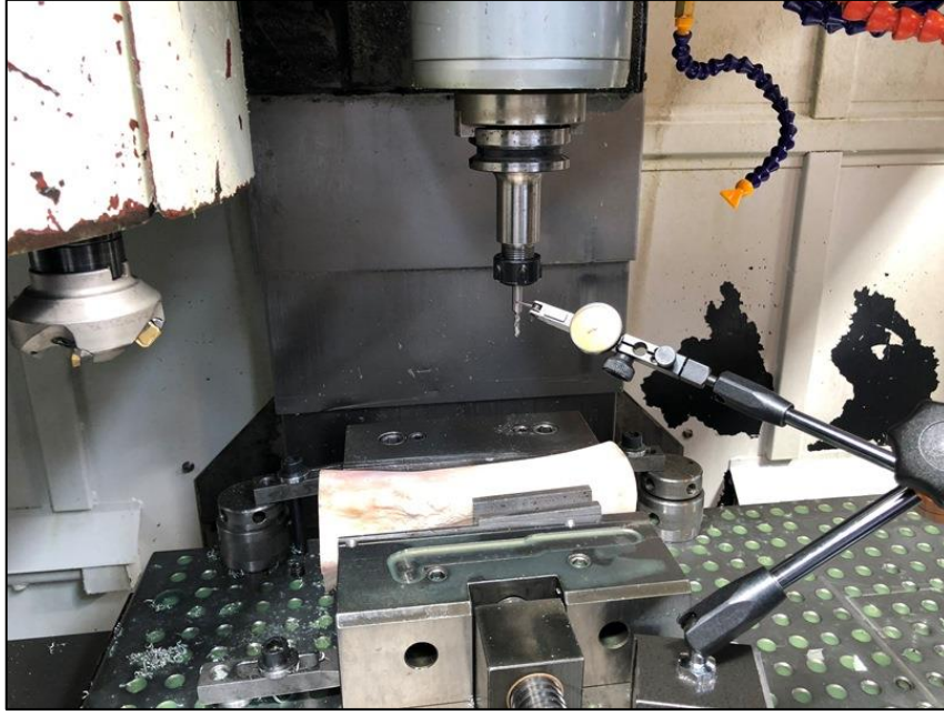
Şekil 4.49. Isınma testleri için CNC frezenin kullanılışı
