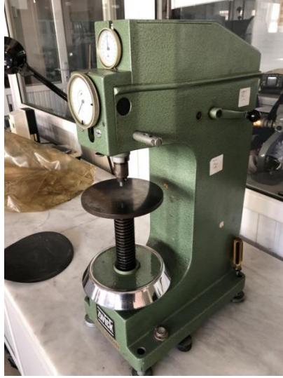
Şekil 4.6. Sertlik ölçüm cihazı (Zwick marka, 3106 model)
