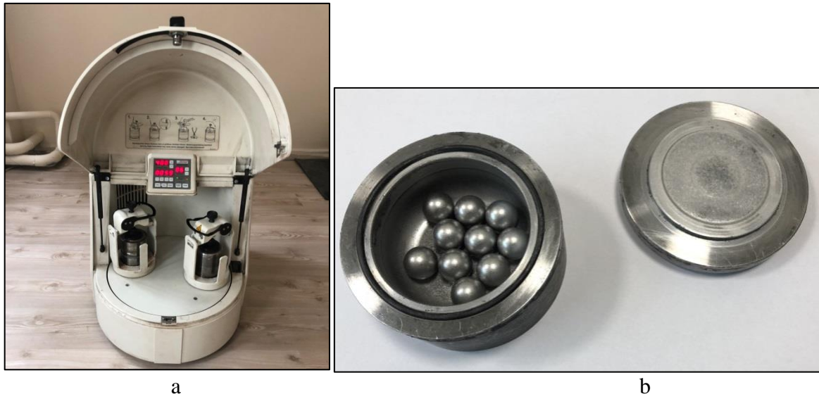
Şekil 4.2. (a) Deneyleerde kullanılan Fritsch, Pulverisette model planetary bilyeli öğütücü. (b) Öğütme kabı ve bilyeler.
