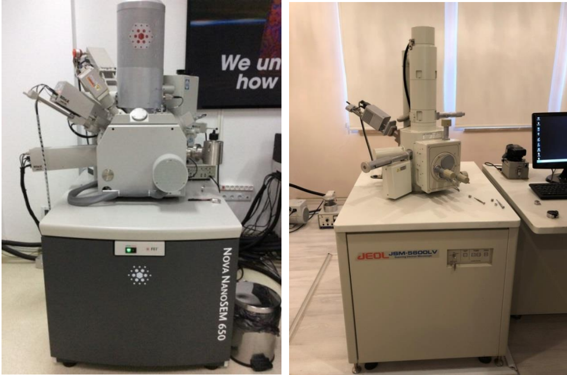
Şekil 4.9. Nova Nanosem marka taramalı elektron mikroskobu (SEM) (a) , Jeol marka taramalı elektron mikroskobu (SEM) (b)
