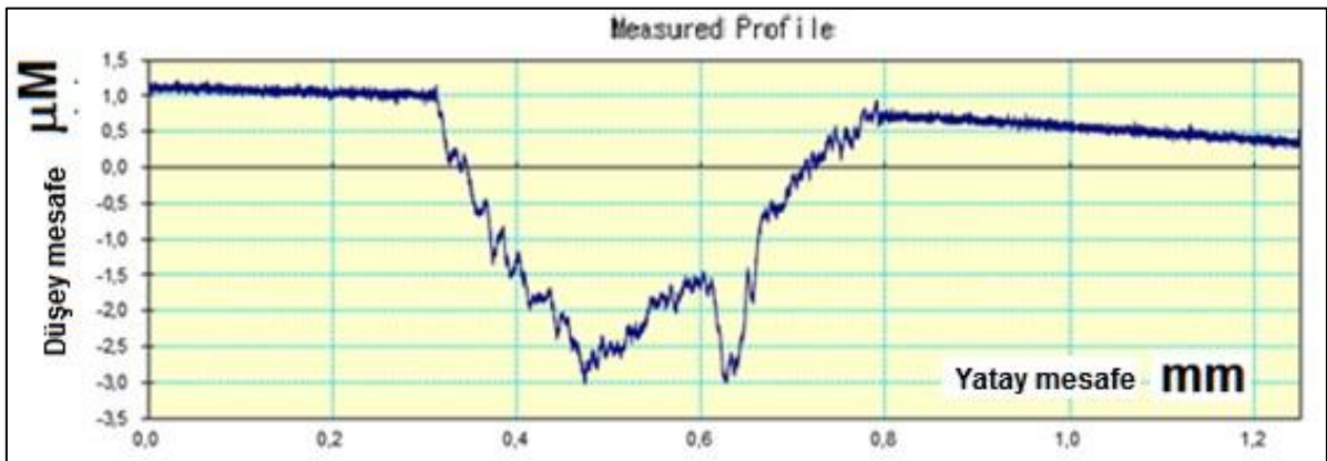
Şekil 4.29. 29 numaralı numunenin (%0,3 B) aşınma test grafiği
