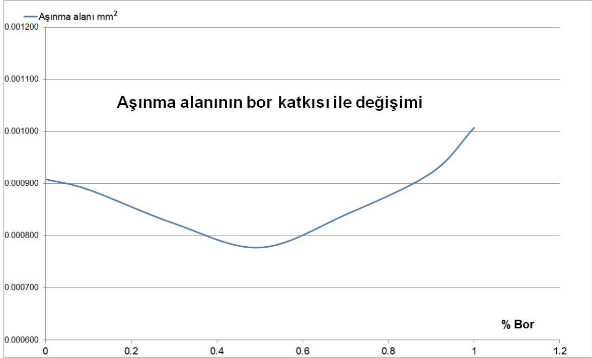
Şekil 4.40. Farklı bor oranına sahip parçaların aşınma alanlarını gösteren grafik
