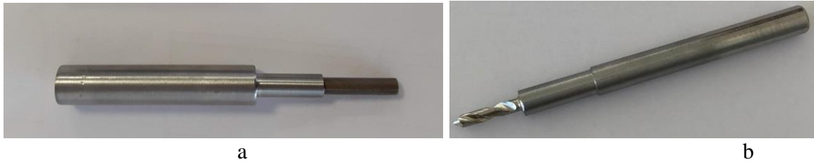
Şekil 4.42. Çıkarılan silindirik parçanın bütünleştirilmiş (a) ve matkap formu işlenmiş hali (b).
