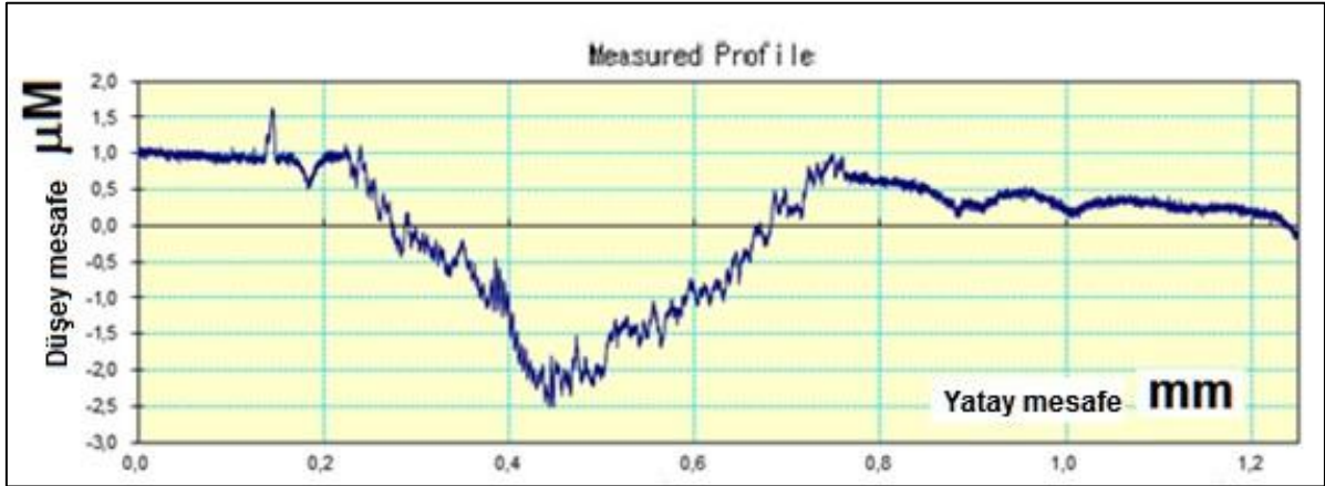
Şekil 4.31. 31 numaralı numunenin (%1 B) aşınma test grafiği
