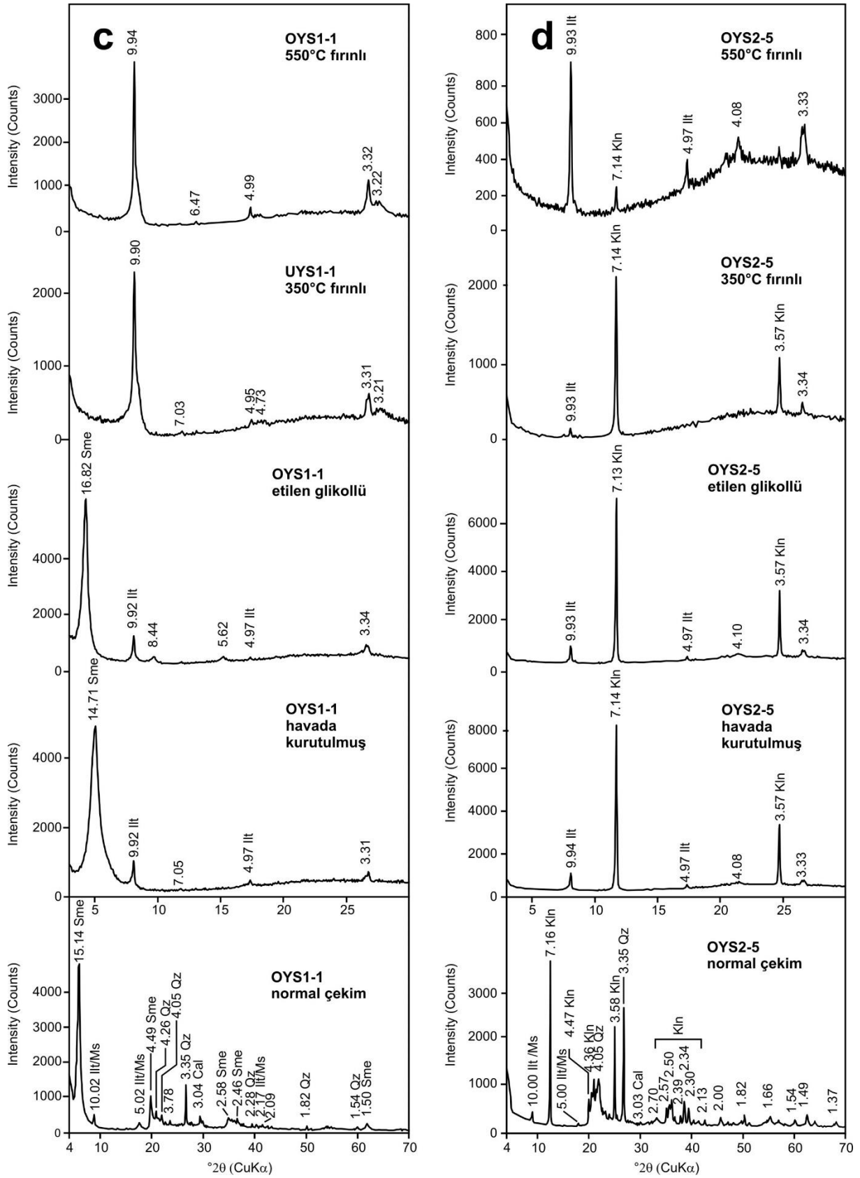
Şekil 5.3. Kaolen ocağı ve yakın çevresinden derlenen örnekler için XRD grafikleri: (c) OYS1-1 örneği, (b) OYS2-5 örneği (Mineral isimlerinin kısaltmaları için Bkz. Çizelge 5.1).
