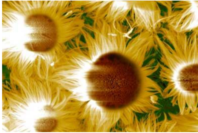
Şekil 4.12. Amorf SiOx nanotelleri kendiliğinden değişik şekiller oluşturulabilmektedir. Nanoteller bu sefer bir ayçiçek şeklini almıştır. Nanotellerin yoğun olarak biriktiği yerler çiçeklerin ortasını; seyrek biriktiği yerler ise sarı yapraklarını oluşturmuştur. Bu da bir taramalı tünellme elektron mikroskobu resmi dir ( http://medikalteknoloji.com/forum-t5192-last.html ).
