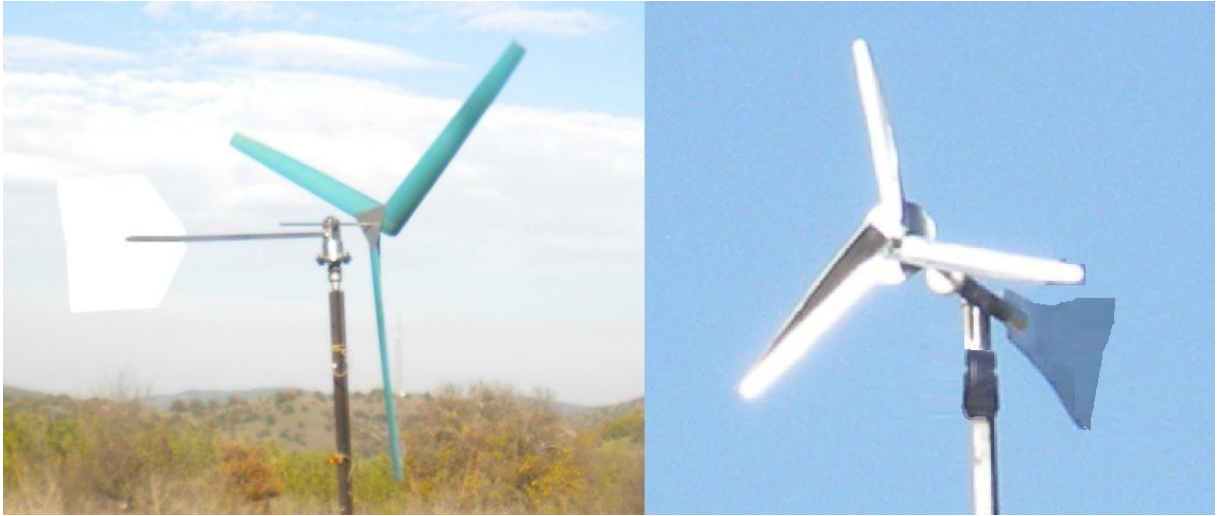
Şekil 3.3. PVC borudan imal edilmiş kanat örnekleri
