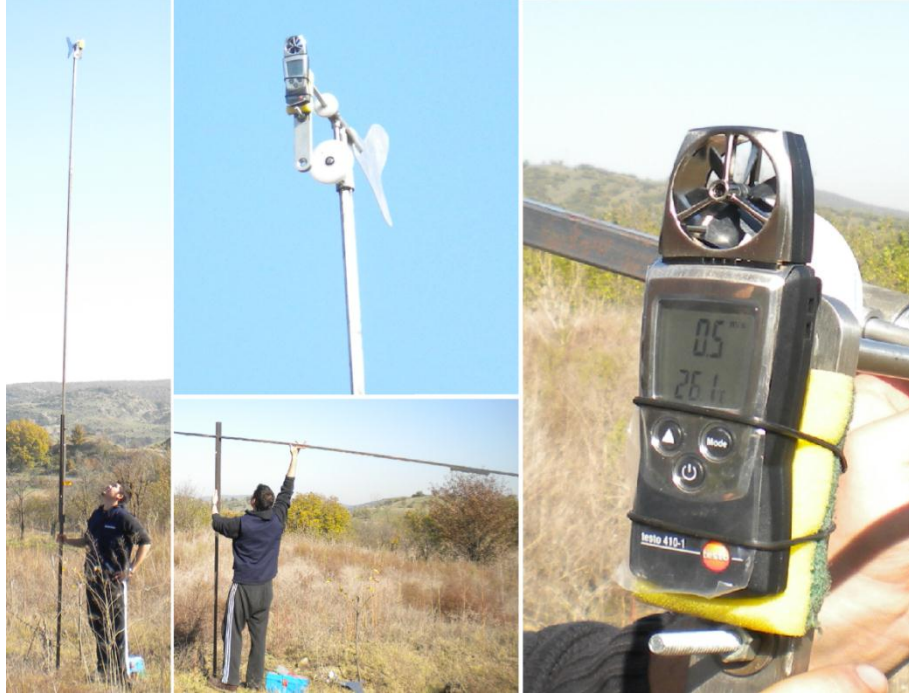
Şekil 2.5. Pazaryeri rüzgar ölçümlerinde kullanılan anemometre ve yardımcı ekipmanlar
