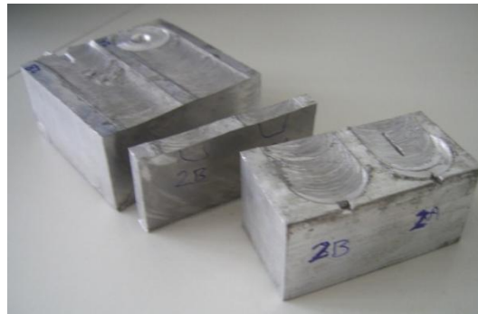
Şekil 6.6. Metalografik çalışmalar için kesiti alınan numune.
