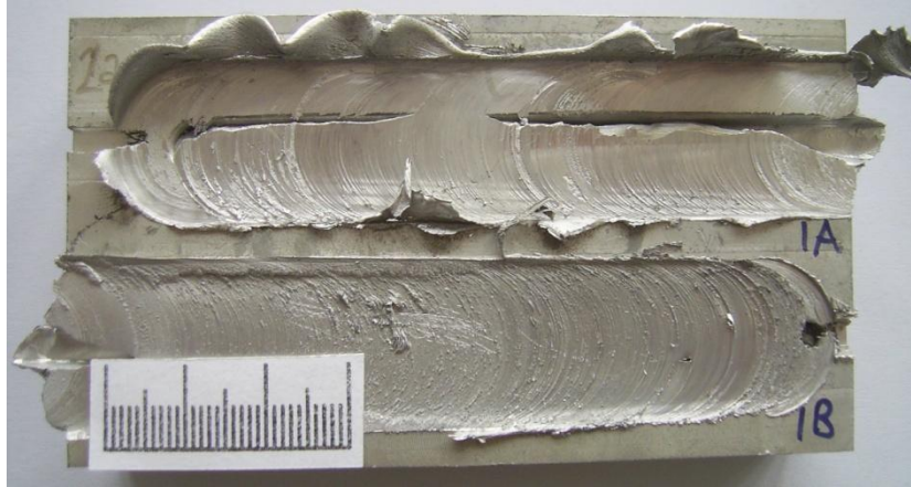
Şekil 7.1. Sürtünme karıştırma prosesi uygulanmış 1 nolu numune, a) tilt açısı uygulanmamış, b) tilt açısı uygulanmış.
