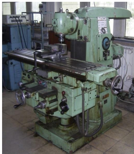
Şekil 6.5. Sürtünme karıştırma prosesinde kullanılan freze tezgahı.
