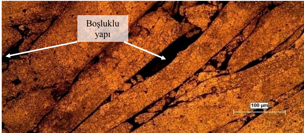
Şekil 7.12. SKP uygulanmış 3 nolu numune, dağlanmış (Keller), 200x
