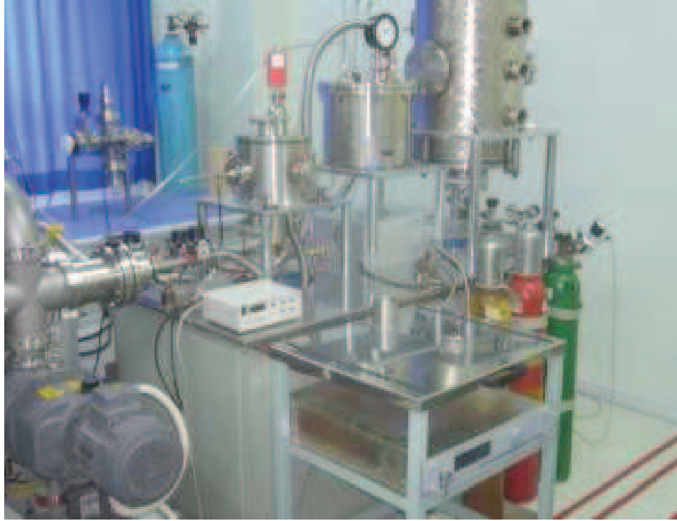
Şekil 6.1 RF saçırma sisteminin fotoğrafı.
