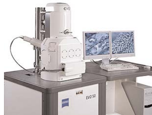
Şekil 6.6. Numune karakterizasyonunda kullanılan SEM/EDS cihazları.
