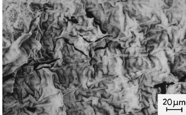
Şekil 4.10. 7 saat boyunca saf oksijen gazına maruz bırakılan Fe-24Al-5Cr alaşımının yüzeyindeki tabaka şekli (Babu et al.,2001).
