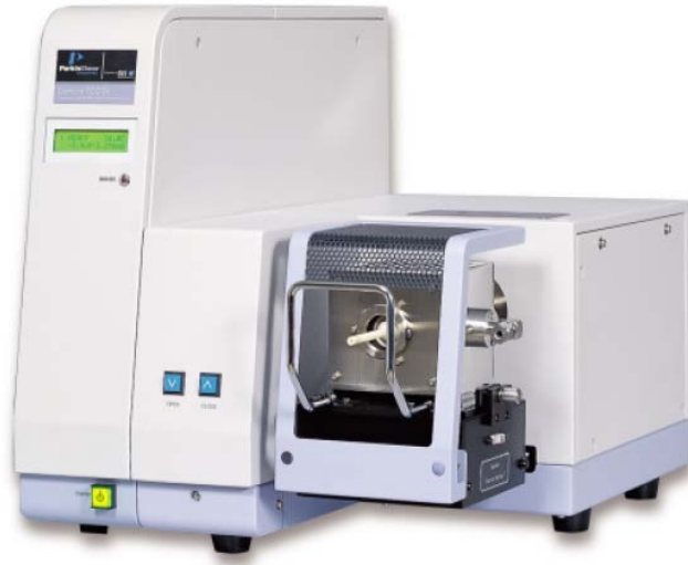
Şekil 6.3. Yüksek sıcaklık gaz korozyonu özelliklerinin tespitinde kullanılan termogravimetri cihazı.
