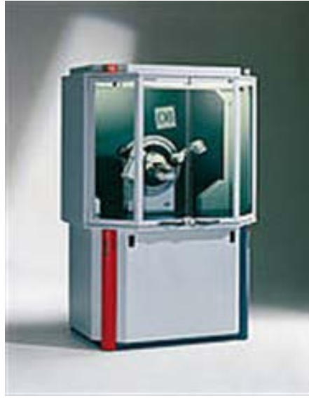
Şekil 6.5. Alaşımların incelenmesinde kullanılan X-ışınları difraktometresi.
