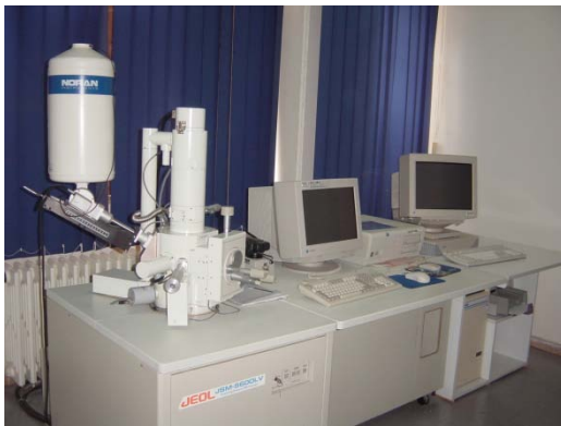
Şekil 6.6. Numune karakterizasyonunda kullanılan SEM/EDS cihazları.
