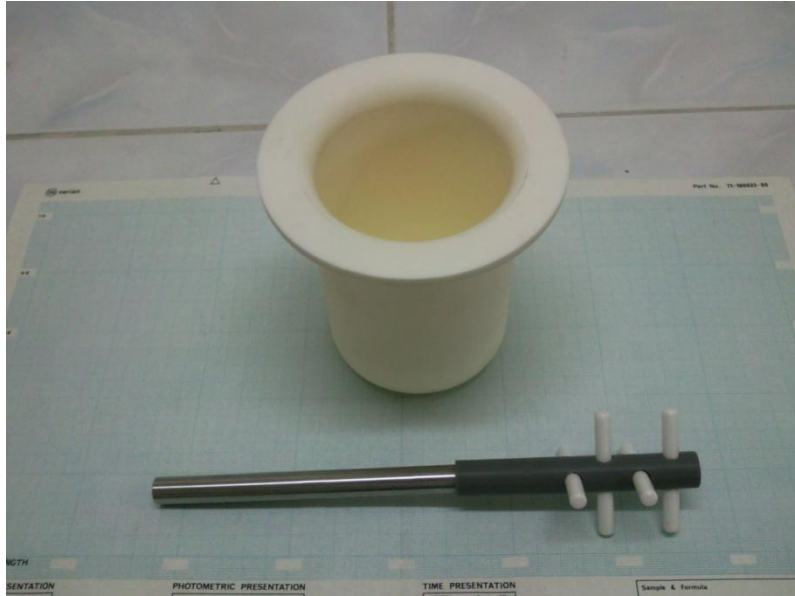
Şekil 6.4. Değirmenin tankı, şaftı ve karıştırma kolları.
