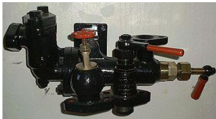
Şekil 3.5. Bir lokomotif kazanının buhar enjektörü
