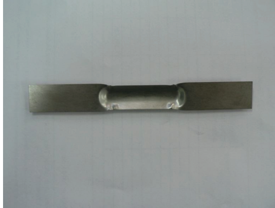
Şekil 6.4 TVA Sisteminde kullanılan yüksek erime sıcaklığına dayanıklı tungsten pota
