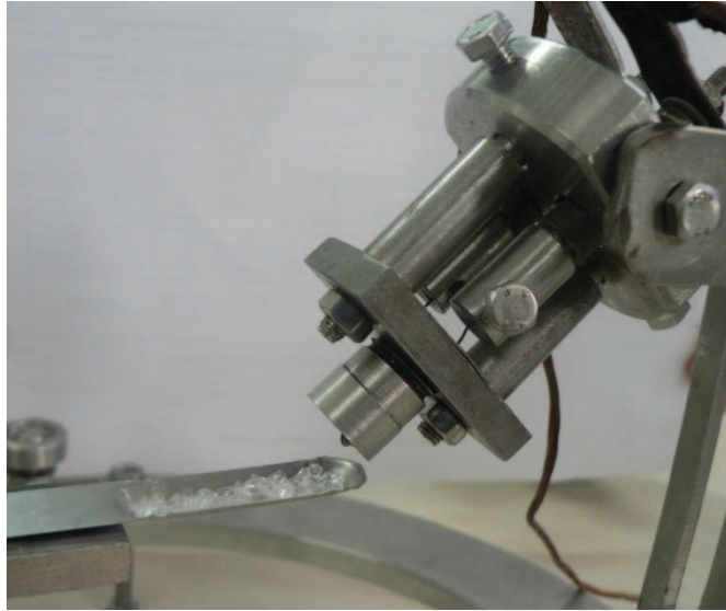
řekil 5.9 TVA Sisteminde pota ve elektron tabancasının konumlandırılmasının fotođrafı
