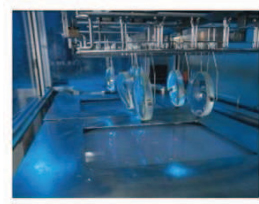
Şekil 2.3 Daldırma Yöntemi ( http://www.cemfa.com/cemfa/makalelerimiz/gozlukcamiteknoloji5.html )
