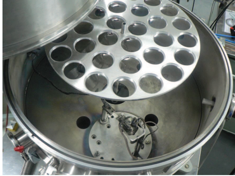
Şekil 5.7 TVA Sisteminde kullanılan gözlük camı tutucusu ve sistemdeki düzenlenişi
