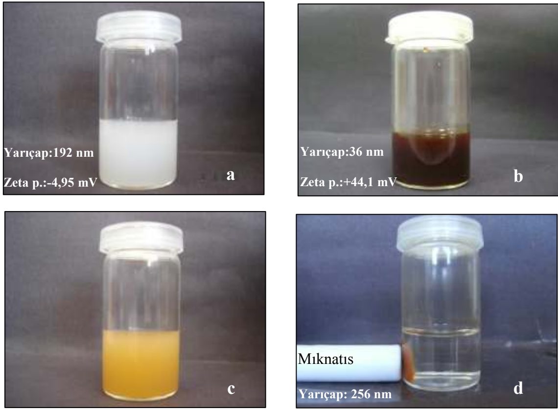
Şekil 5.34. Manyetik partikül ve mikrojel etkileşiminin basamaklarını gösteren dijital fotoğraflar (a) Sulu PMEMA mikrojel çözeltisi (pH 7-8) (b) Hidrofilik asidik Fe_3O_4 manyetik partikülleri (c) Mikrojel ve manyetik partikül içeren karışım (pH 7-8) (d) Miknatis yardımıyla mikrojel ve manyetik partiküllerin toplanması
