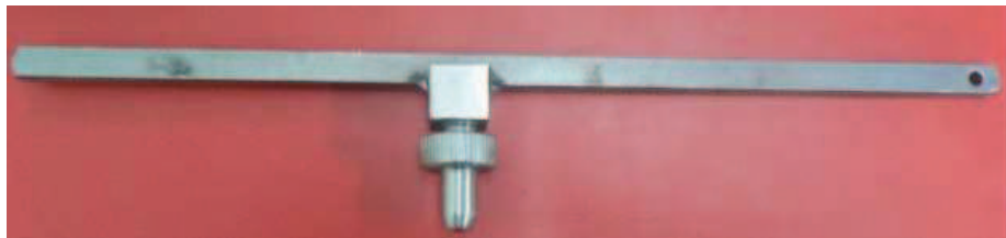
Şekil 6.9 Yük kolu ve aşındırıcı tutan elemanın fotoğrafı
