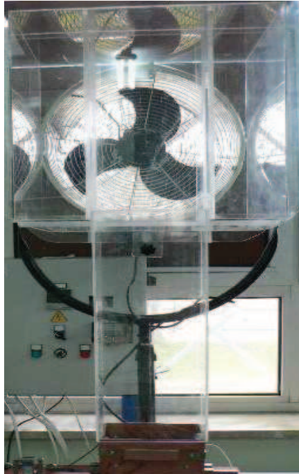
Őekil 6.16 Havalandırma sisteminin fotođrafı
