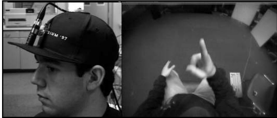
Şekil 1-3: Şapkaya takılı kamera ile işaret dili tanırna
