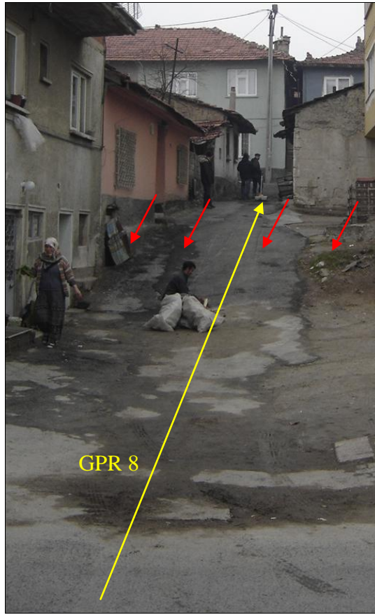
Şekil 3.40. Kütahya şehir merkezinin yaklaşık 2 km kuzeybatısında GPR 8 profilinin alındığı lokasyon. Bakış yönü güneye doğrudur. Kırmızı oklar fayın muhtemel yerini ve morfolojik sarplığı, sarı çizgi ve ok GPR profillerinin alındığı yerleri ve gidiş yönünü göstermektedir.
