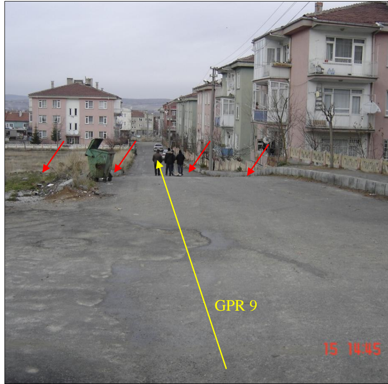
Şekil 3. 42. Kütahya şehir merkezinin yaklaşık 3 km güneydoğusunda alınan GPR 9 profili. Bakış yönü yaklaşık kuzeydoğudur. Kırmızı oklar fayın muhtemel yerini ve morfolojik sarplığı, sarı çizgi ve ok GPR profillerinin alındığı yerleri ve gidiş yönünü göstermektedir.
