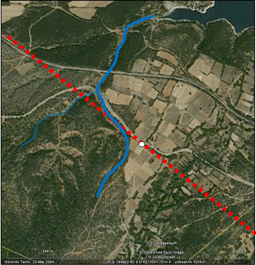
Şekil 3.26. Kütahya'nın yaklaşık 15 km kuzeybatısında yer alan Karabacak sırtının hemen batısındaki Erikboğaz deresinin zayıf zonu kullanması sonucu sola doğru anidönüşü (Görüntü Google Earth'den alınmıştır) (Mavi çizgiler Erikboğaz deresini, kırmızı kesikli çizgi derenin dönüşüne sebep olan zayıf zonu, beyaz nokta ise şekil 3.36'da gösterilmiş olan alanı işaret etmektedir).
