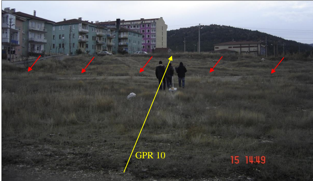
Şekil 3.44. Kütahya şehir merkezinin yaklaşık 3 km güneydoğusunda alınan GPR 10 profili. Bakış yönü güneybatıdır. Kırmızı oklar fayın muhtemel yerini ve morfolojik sarpılığı, sarı çizgi ve ok GPR profillerinin alındığı yerleri ve gidiş yönünü göstermektedir. Fotoğrafta ayrıca KFZ'nun aktif olmayan kısmına ait fay morfolojisi de görülmektedir.
