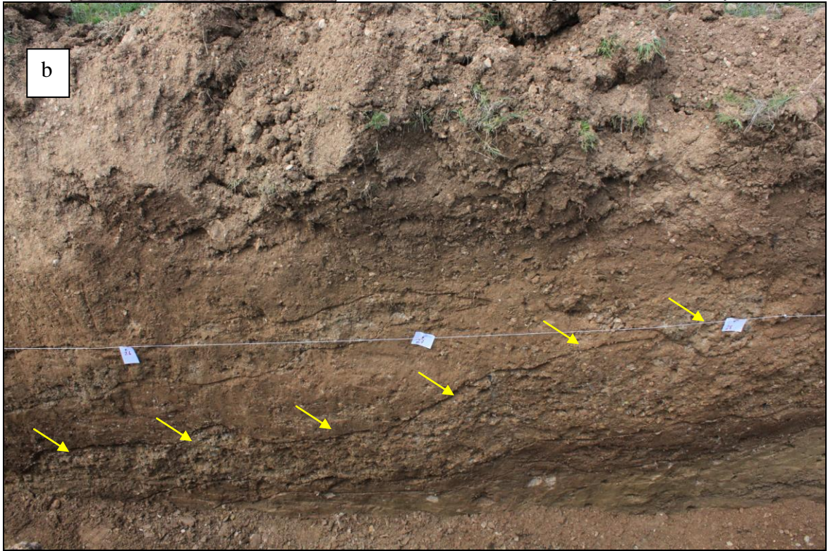
Şekil 3.51. a. Okçu hendeğinde süreksizlik zonunun gözlemlendiği kesimin logu b. hendek doğu duvarında faylanmaya ait izler.
