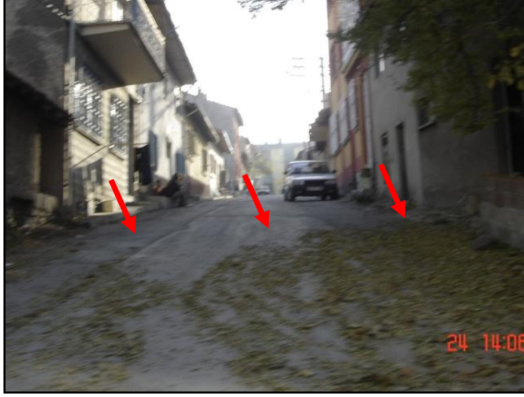
Şekil 3.19. Aktif faylanmanın izleri şehir merkezinin yaklaşık 2 km batısındaki sokaklarda da gözlenebilmektedir. Kırmızı oklar bu alanlarda belli bir doğrultuda uzanmakta olan fay sarplıklarının göstermektedir. Bakış yönü güneye doğrudur. ( WGS 84 sisteminde GPS Koordinatları: 0754962D,4368642K)
