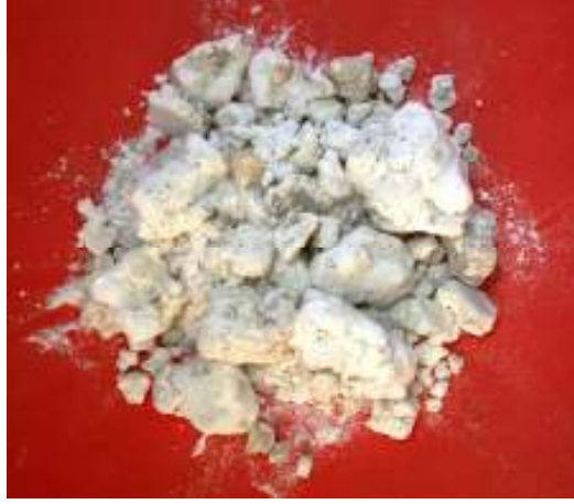
Şekil 5.13. 500 °C - 30 Dk. Deney Şartlarında Patlatılan Tinkal
