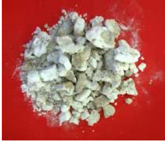
Şekil 5.3. 450 °C - 30 Dk. Deney Şartlarında Patlatılan Tinkal
