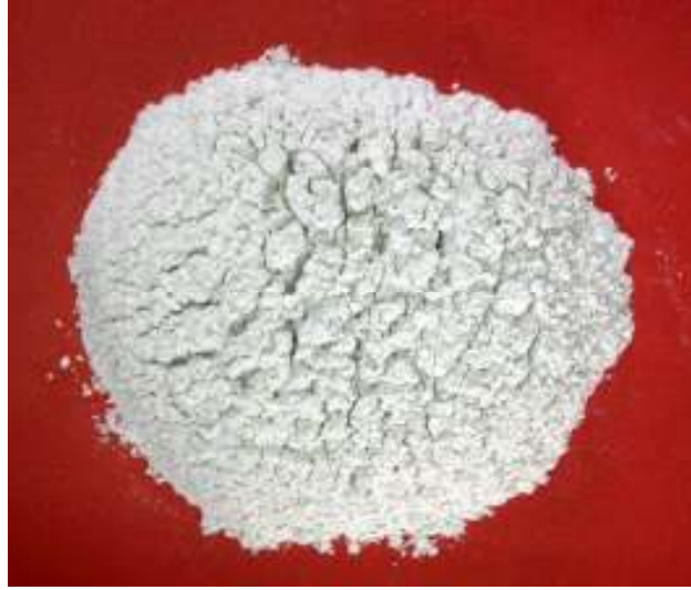
Şekil 5.27. Ufalama-Eleme İşlemi Sonrası Elde Edilen Konsantre
