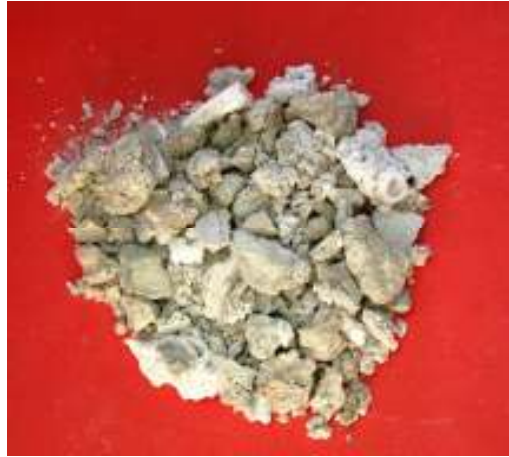
Şekil 5.9. 500 °C - 10 Dk. Deney Şartlarında Patlatılan Tinkal
