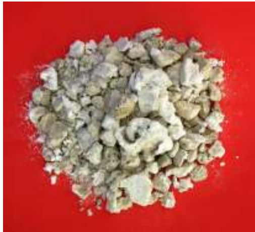
Şekil 5.2. 450 °C - 25 Dk. Deney Şartlarında Patlatılan Tinkal
