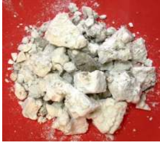
Şekil 5.14. 500 °C - 35 Dk. Deney Şartlarında Patlatılan Tinkal
