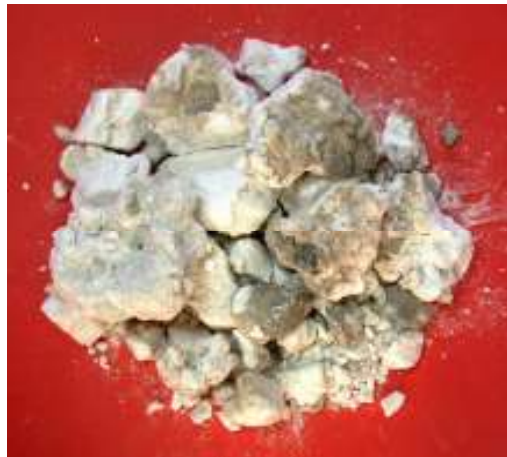
Şekil 5.25. 600 °C - 20 Dk. Deney Şartlarında Patlatılan Tinkal
