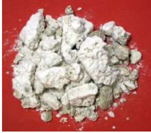
Şekil 5.17. 550 °C - 15 Dk. Deney Şartlarında Patlatılan Tinkal
