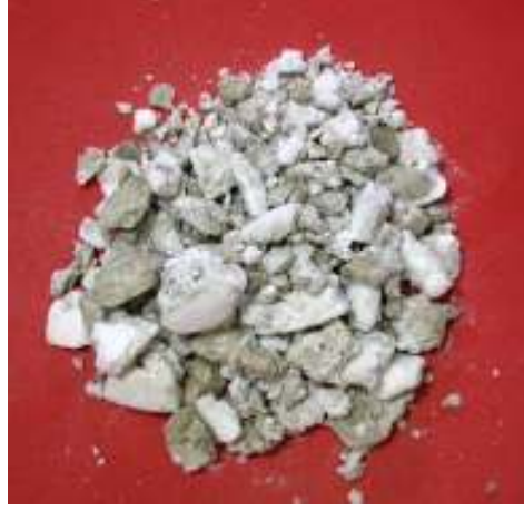
Şekil 5.16. 550 °C - 10 Dk. Deney Şartlarında Patlatılan Tincal
