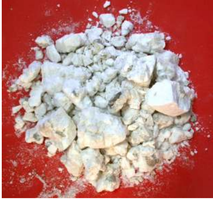
Şekil 5.19. 550 °C - 25 Dk. Deney Şartlarında Patlatılan Tinkal
