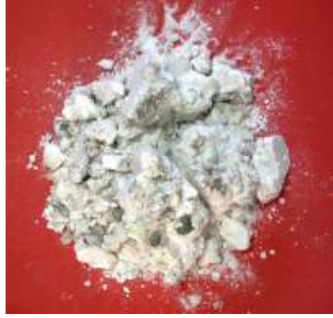
Şekil 5.20. 550 °C - 30 Dk. Deney Şartlarında Patlatılan Tinkal
