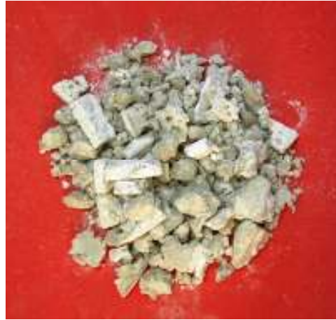
Şekil 5.22. 600 °C - 5 Dk. Deney Şartlarında Patlatılan Tinkal
