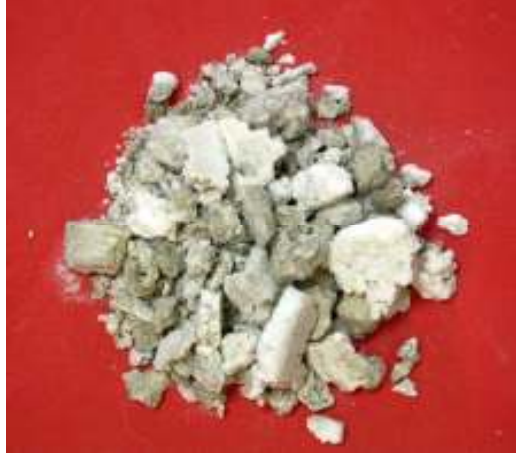
Şekil 5.10. 500 °C - 15 Dk. Deney Şartlarında Patlatılan Tinkal
