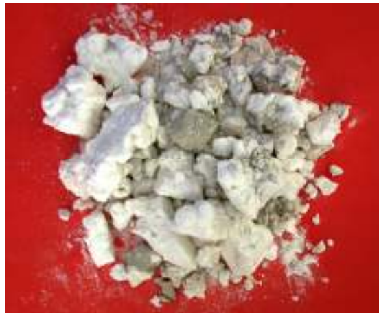
Şekil 5.5. 450 °C - 40 Dk. Deney Şartlarında Patlatılan Tinkal
