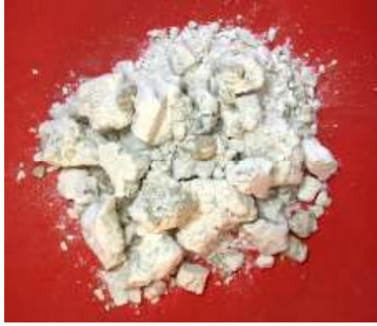
Şekil 5.12. 500 °C - 25 Dk. Deney Şartlarında Patlatılan Tinkal
