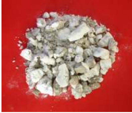
Şekil 5.4. 450 °C - 35 Dk. Deney Şartlarında Patlatılan Tinkal
