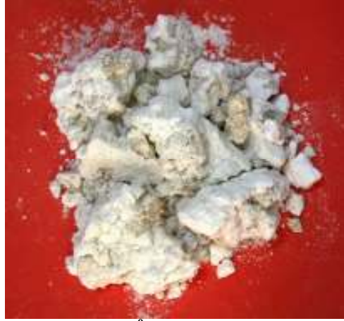
Şekil 5.24. 600 °C – 15 Dk. Deney Şartlarında Patlatılan Tinkal
