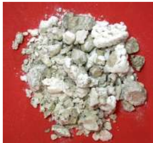
Şekil 5.11. 500 °C - 20 Dk. Deney Şartlarında Patlatılan Tinkal
