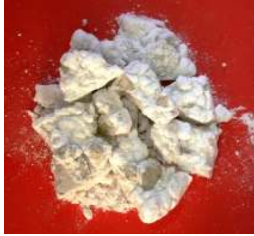
Şekil 5.23. 600 °C - 10 Dk. Deney Şartlarında Patlatılan Tinkal
