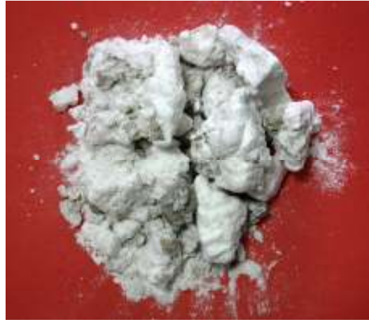
Şekil 5.7. 450 °C - 50 Dk. Deney Şartlarında Patlatılan Tinkal
