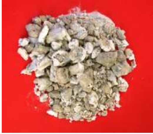
Şekil 5.1. 450 °C / 20 Dk. Deney Şartlarında Patlatılan Tinkal
