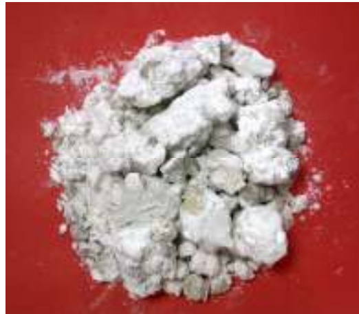
Şekil 5.6. 450 °C - 45 Dk. Deney Şartlarında Patlatılan Tinkal
