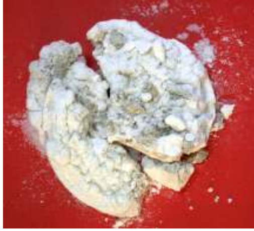
Şekil 5.18. 550 °C - 20 Dk. Deney Şartlarında Patlatılan Tinkal
