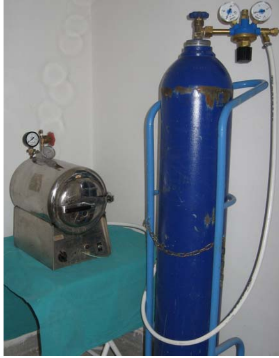
Şekil 3.17. Eskişehir Asker Hastanesi GATA Hava ve Uzay Hekimliği Kliniği tarafından, deneysel amaçla kullanılmak üzere tasarlanan düzenek. Düzenek O 2 kaynağı olarak kullanılan sanayi tipi bir tüp, deneklere uygulamanın yapıldığı odacık ve ara bağlantı hortumundan oluşmaktadır.
