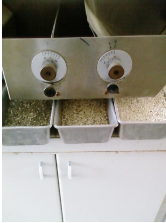
Şekil 5.4. Ürünleri Manyetik Özelliklerine Göre Ayırma.
