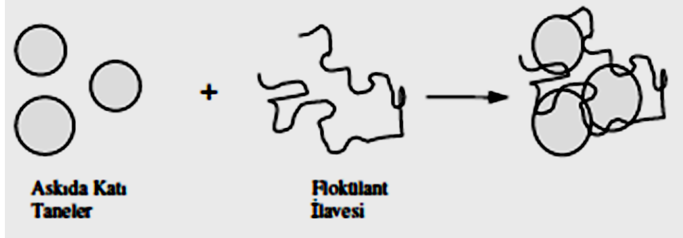
Şekil 2.5. Polimer Köprü Teşekkülü İle Askıda Katı Tanelerin Flokülasyonu
