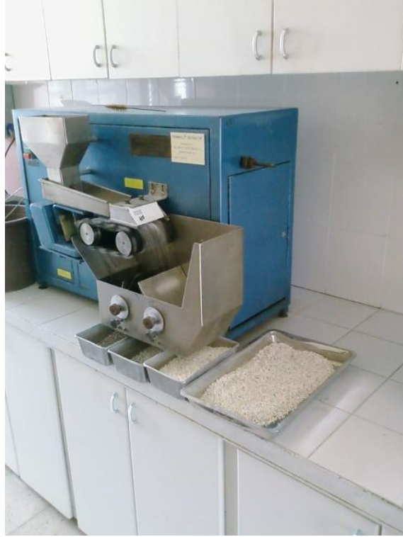
Şekil 5.3. Permroll Doğal Mıknatıslı Tamburlu Manyetik Ayırıcı.
