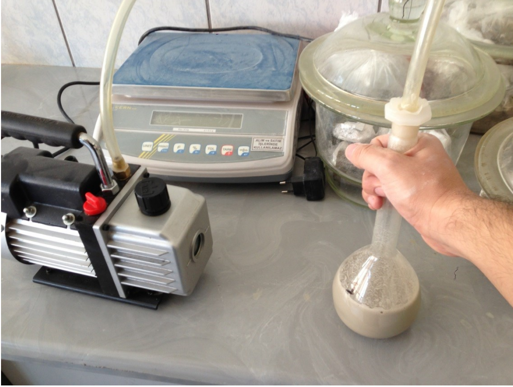
Şekil 5.5. Özgül ağırlık deneyinde vakum uygulaması
