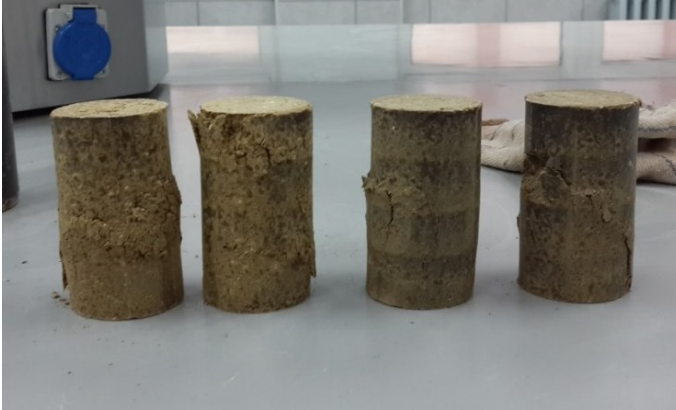
Şekil 6.15. Serbest basınç deney sonu görünüm
