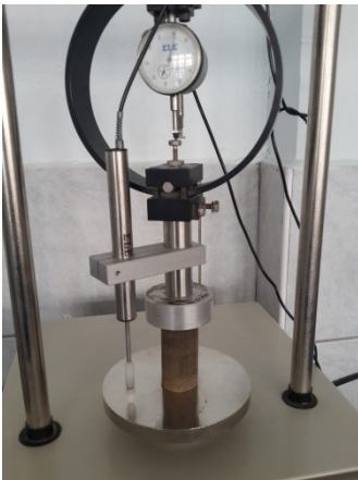
Şekil 5.11. Serbest basınç deney sistemi
