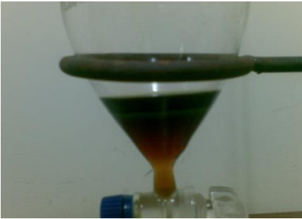
Şekil 3.3. V. exuberans ekstresine ait sıvı-sıvı ekstraksiyonu.
