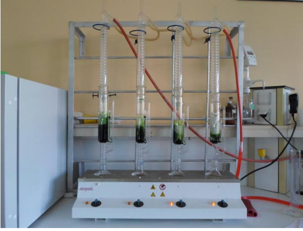
Şekil 3.2. V. exuberans bitkisinin soxhlet ekstraktöründe ekstre edilmesi.
