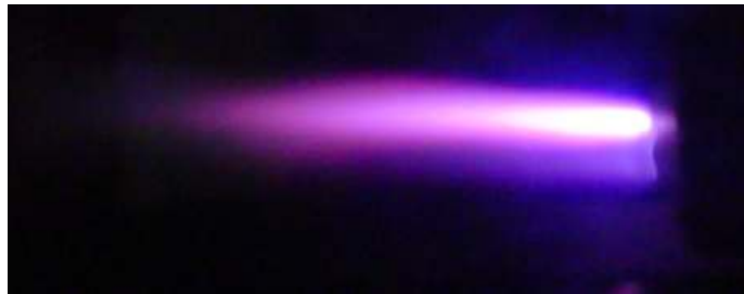
Şekil 5.9 İkinci Plazma Tabancasında elde edilen Argon gazı plazma jetinin fotoğrafı (V= 500 Volt, P=5 Torr).
