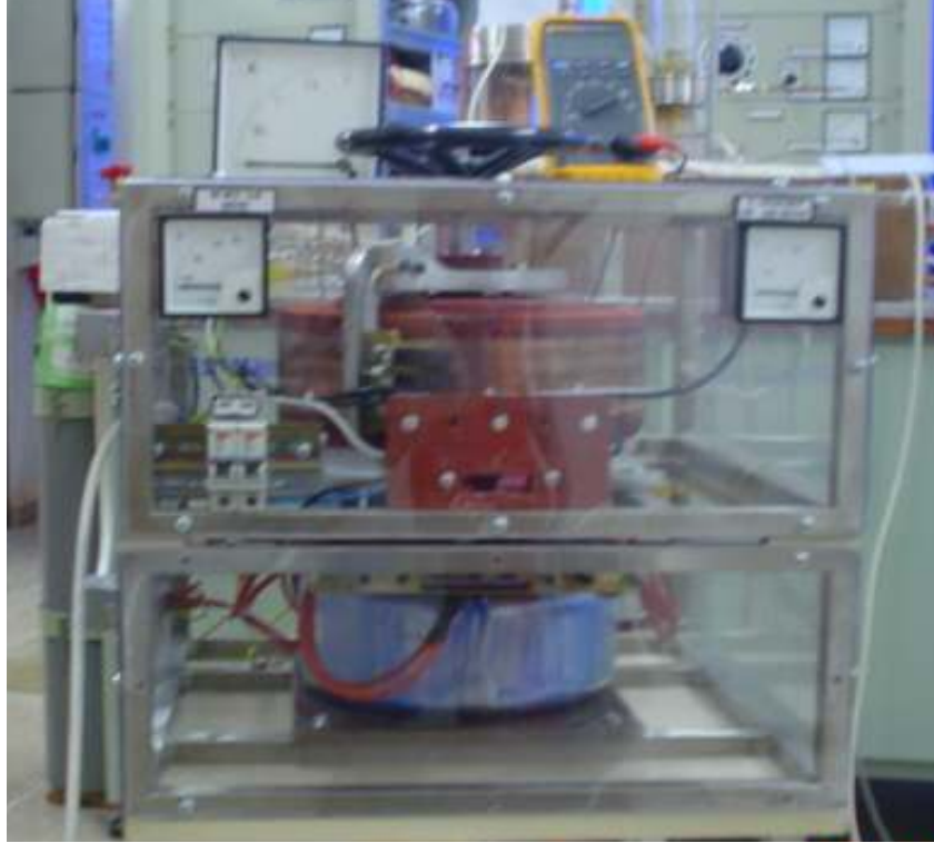
Şekil 5.4 Taşınabilir 3.5 kV'luk DC güç kaynağının fotoğrafı.
