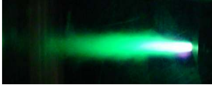
Şekil 5.11 İkinci Plazma Tabancasında elde edilen Argon gazı plazma jetinin fotoğrafı (V= 430 Volt, P=11 Tor).
