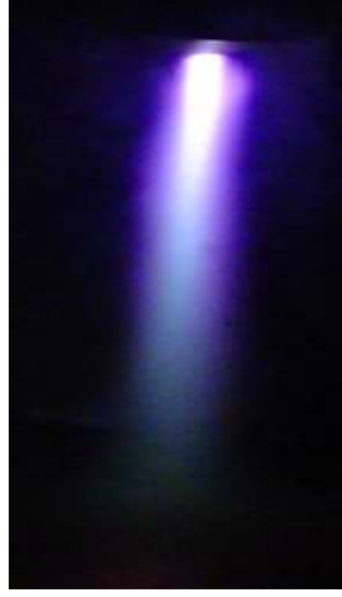
Şekil 5.8 Birinci plazma tabancasındaki Argon gazı plazma jetinin fotoğrafı.
