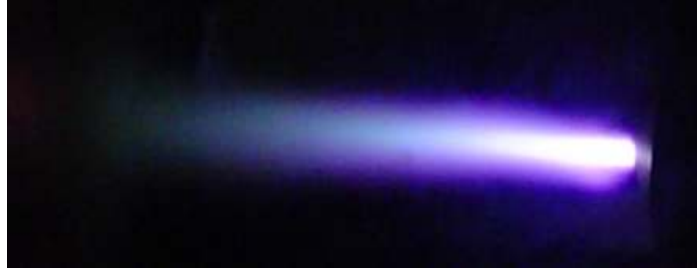
Şekil 5.10 İkinci Plazma Tabancasında elde edilen Argon gazı plazma jetinin fotoğrafı (V= 400 Volt, P=8,5 Torr).
