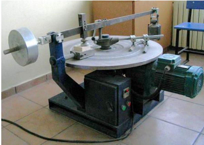
Şekil 5.7. Böhme yüzey aşındırma cihazı
