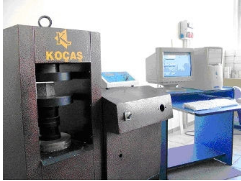
Şekil 5.5. Tek eksenli basınç dayanımı deney presi
