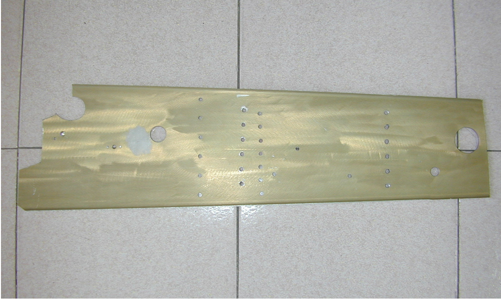
Şekil 4.3. Boya sökümü sonrası numune
