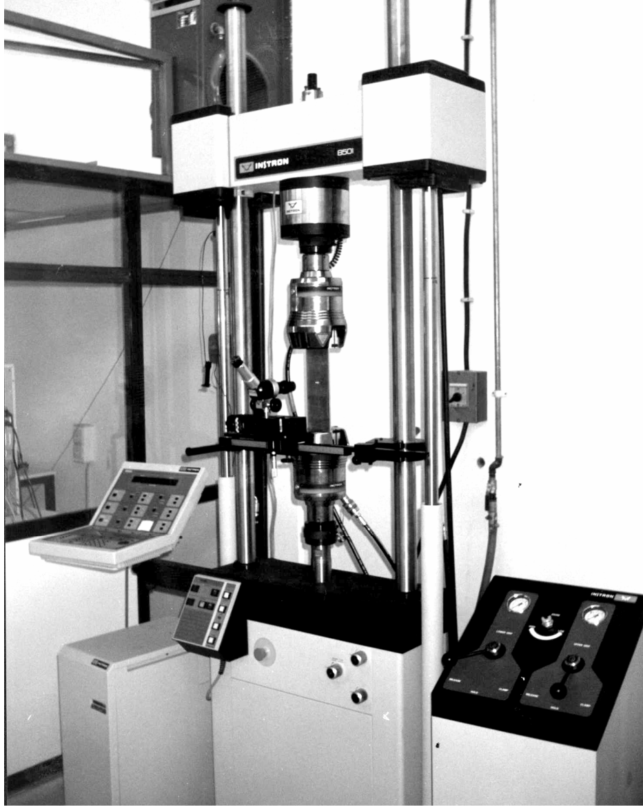
Şekil 4.17. Yorulma deneyinde kullanılan Instron 8500 cihazı
