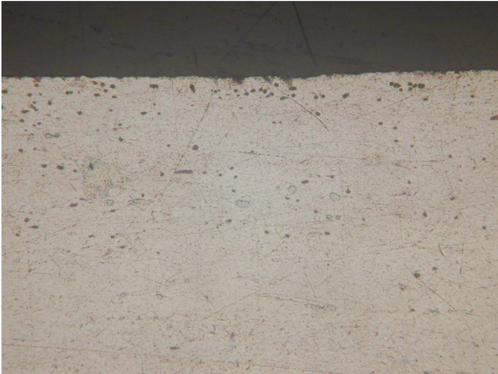
Şekil 4.15. Termomekanik işlem gören numunenin mikroyapı görüntüsü (200 x)
