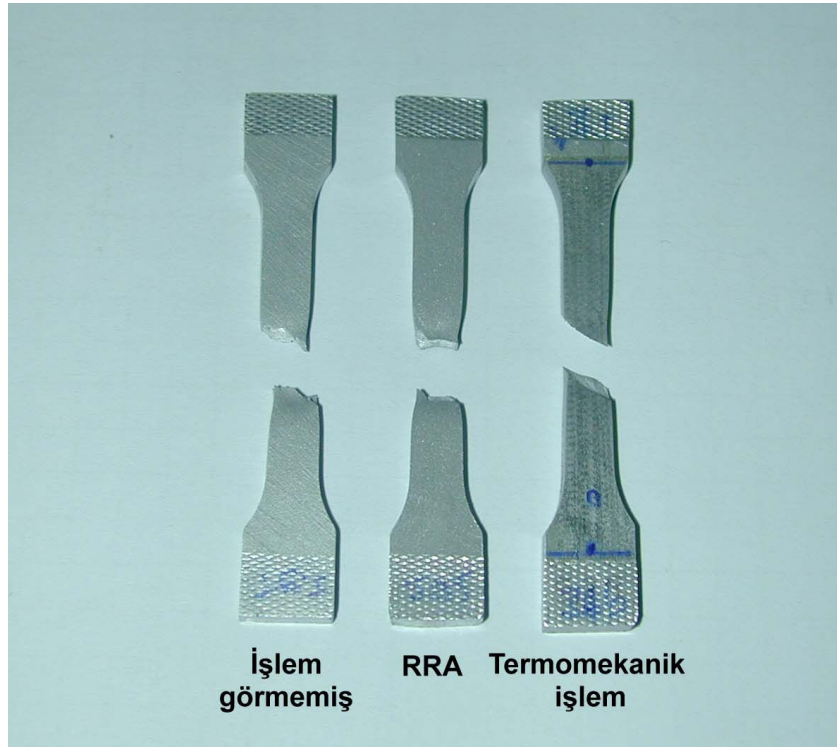
Şekil 4.19. Çekme deneyi sonrası numuneler
