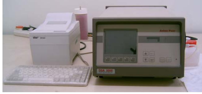
Şekil 5.2. Yoğunluk ve ultrases hızı ölçüm cihazı (Anton Paar DSA5000)
