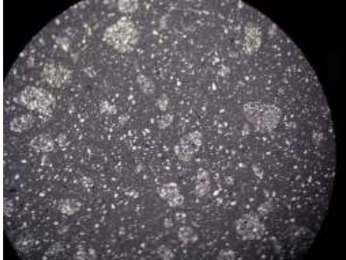
Şekil 6.5 Öğütülmüş cevherin -25µm boyut fraksiyonundaki parlak kesit görüntüsü (Büyütme Oranı: x600).
