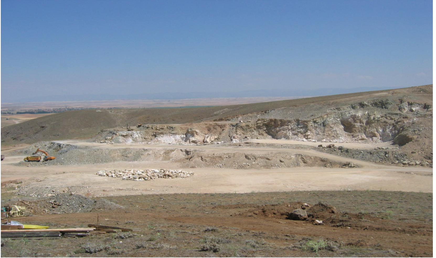
Şekil 5.26. Beylikova manyezit açık ocağında 2004 yılında yapılan basamaklandırma çalışması
