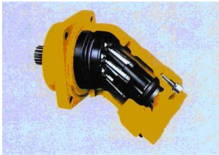
Şekil 4.2. Sabit Deplasmanlı Eğik Eksenli Pistonlu Pompa(Ostendorff,2006)[20]
