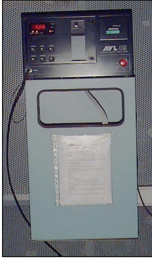
Şekil 7.5 Duman cihazı genel görünüm
