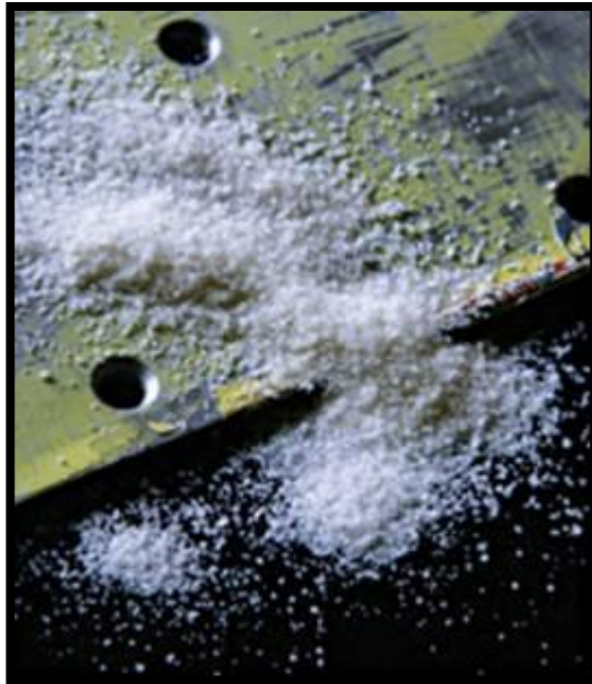
Şekil 4.9. Boya sökmede aşındırıcı parçacık olarak kullanılan mısır unu
