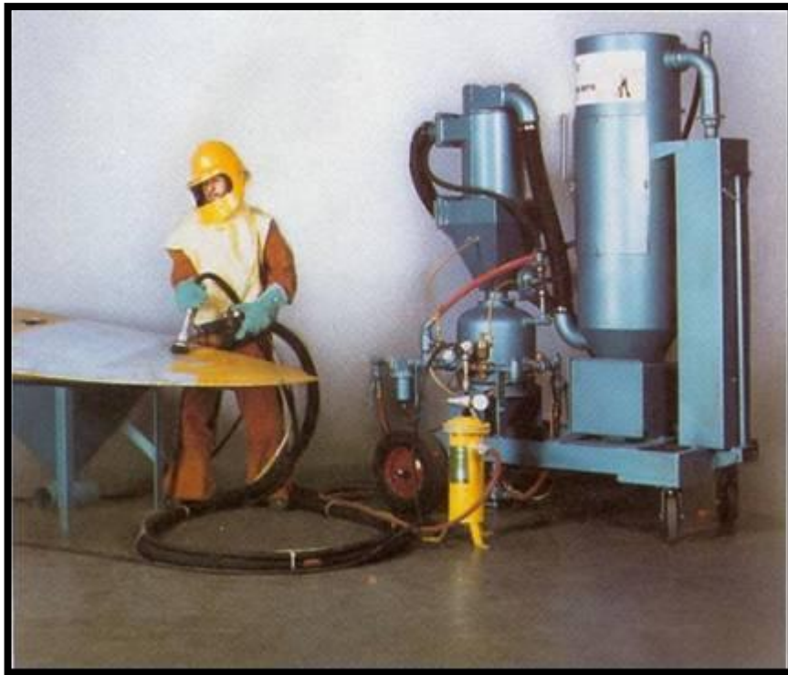
Şekil 4.5. Plastik parçacık püskürtme yöntemi ile bir uçak parçası üzerinde boya sökme.
