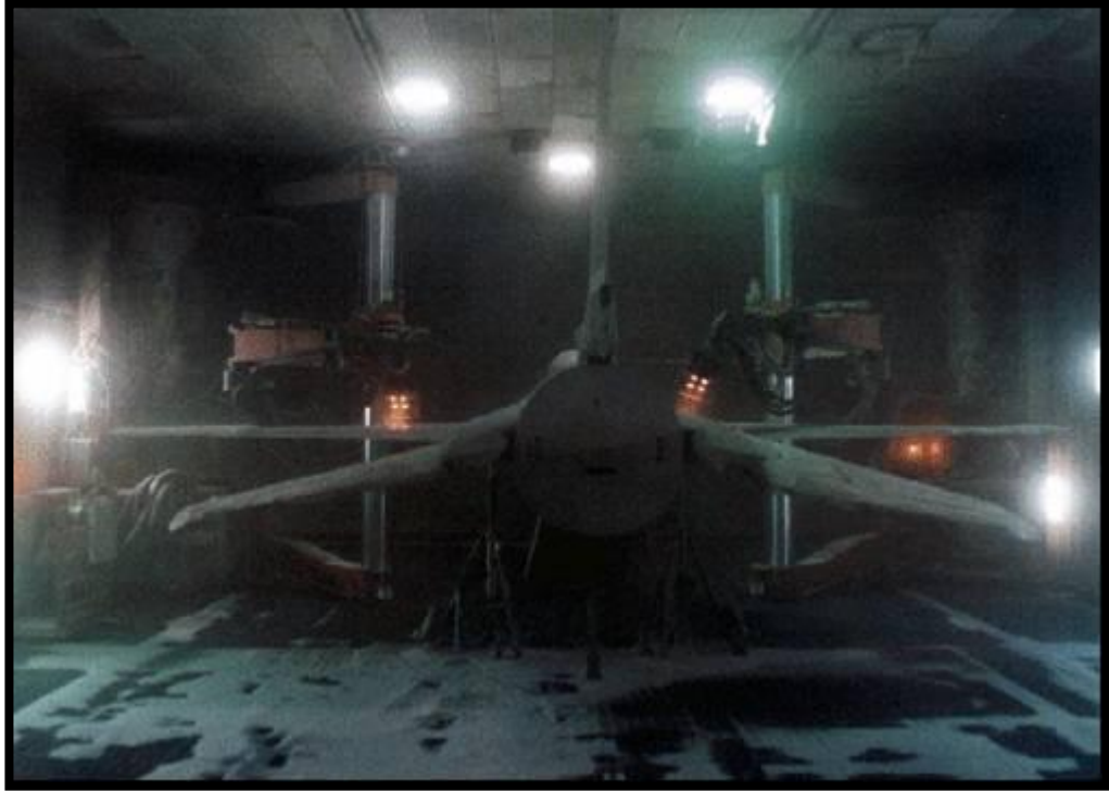
Şekil 4.11. F-16 uçağında robotlu boya sökme operasyonu
