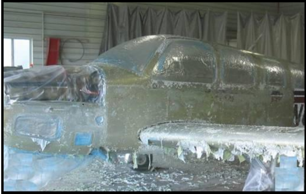
Şekil 4.3. Kimyasal yöntem ile bir uçak üzerinde boya sökme
