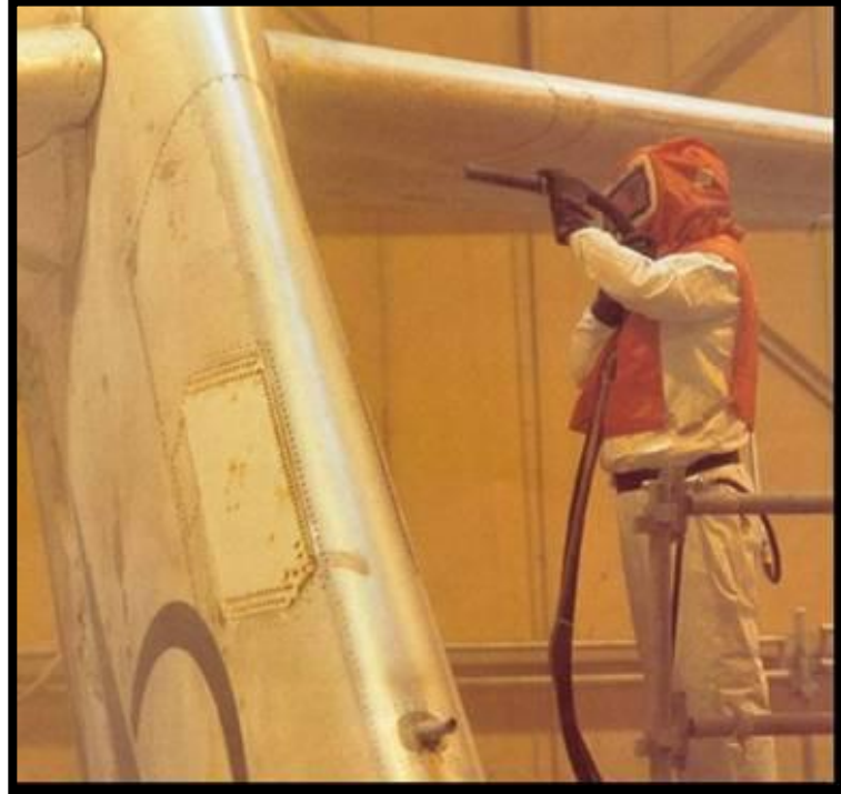
Şekil 4.6. Plastik parçacık püskürtme yöntemi ile DC-9 uçağı üzerinde boya sökme.
