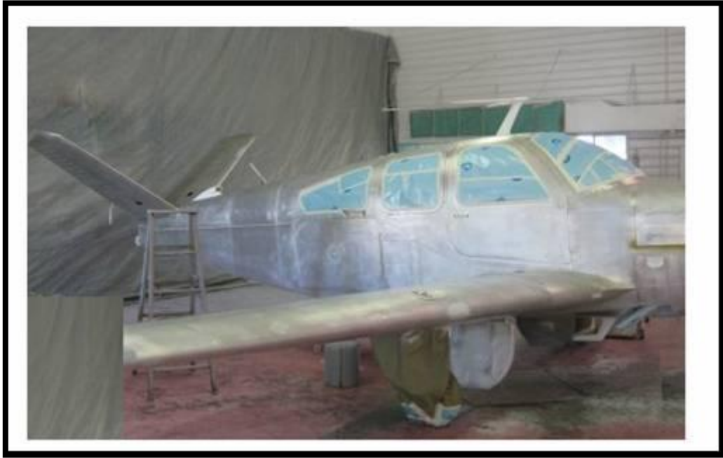
Şekil 4.4. Boya sökme işlemi ve alodin uygulanmış bir uçak.
