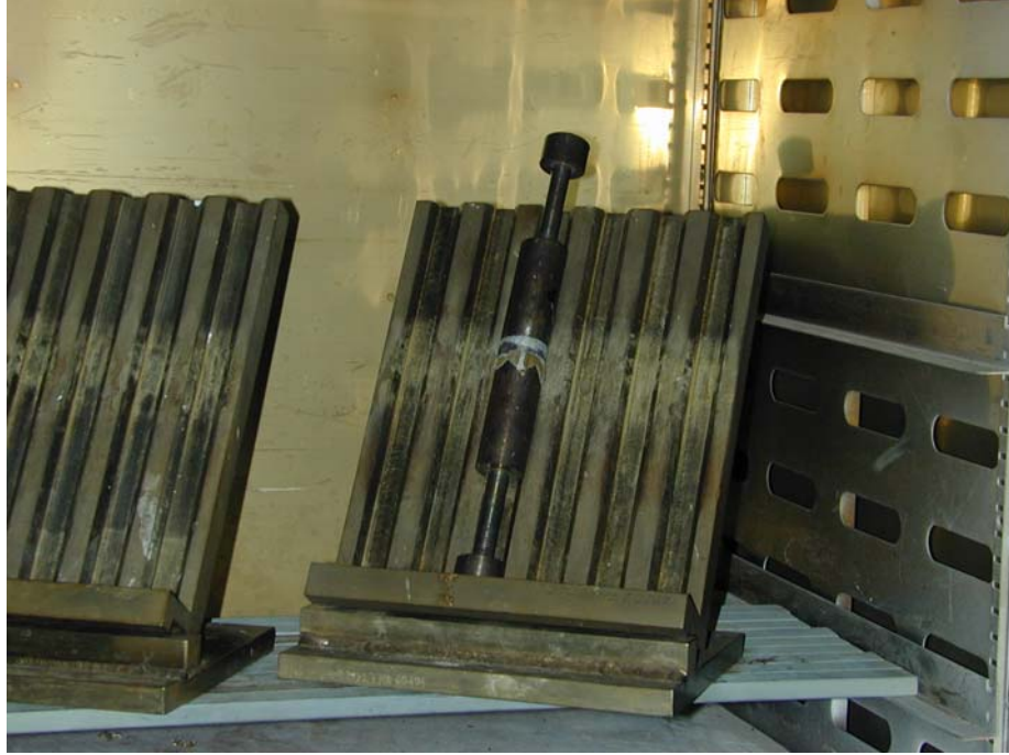
Şekil 3.2. Fırın içerisinde yapıştırıcı kürleşme işlemine tabi tutulmuş, fikstür yardımıyla çekme çubuğu haline gelmiş çekme test numunesi.
