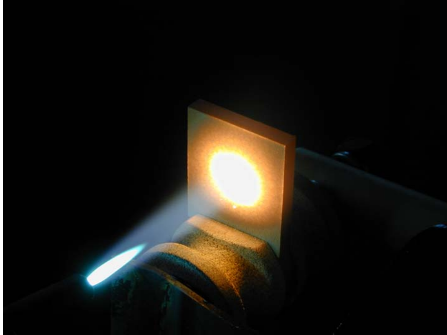
Şekil 3.6. Termal şok test numunesi (seramik yüzey).
