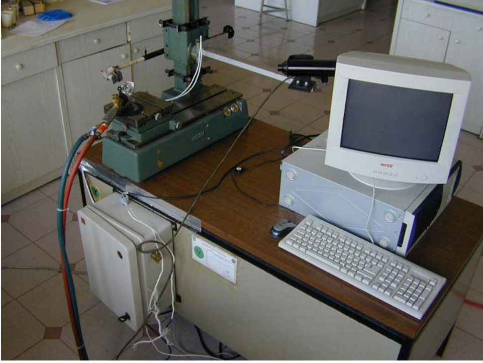
Şekil 3.4. Termal şok test düzeneği.
