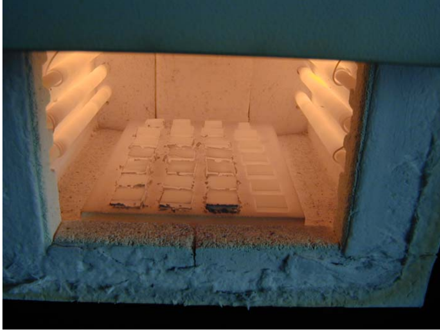
Şekil 3.3. Fırın içerisinde oksidasyon test numuneleri.
