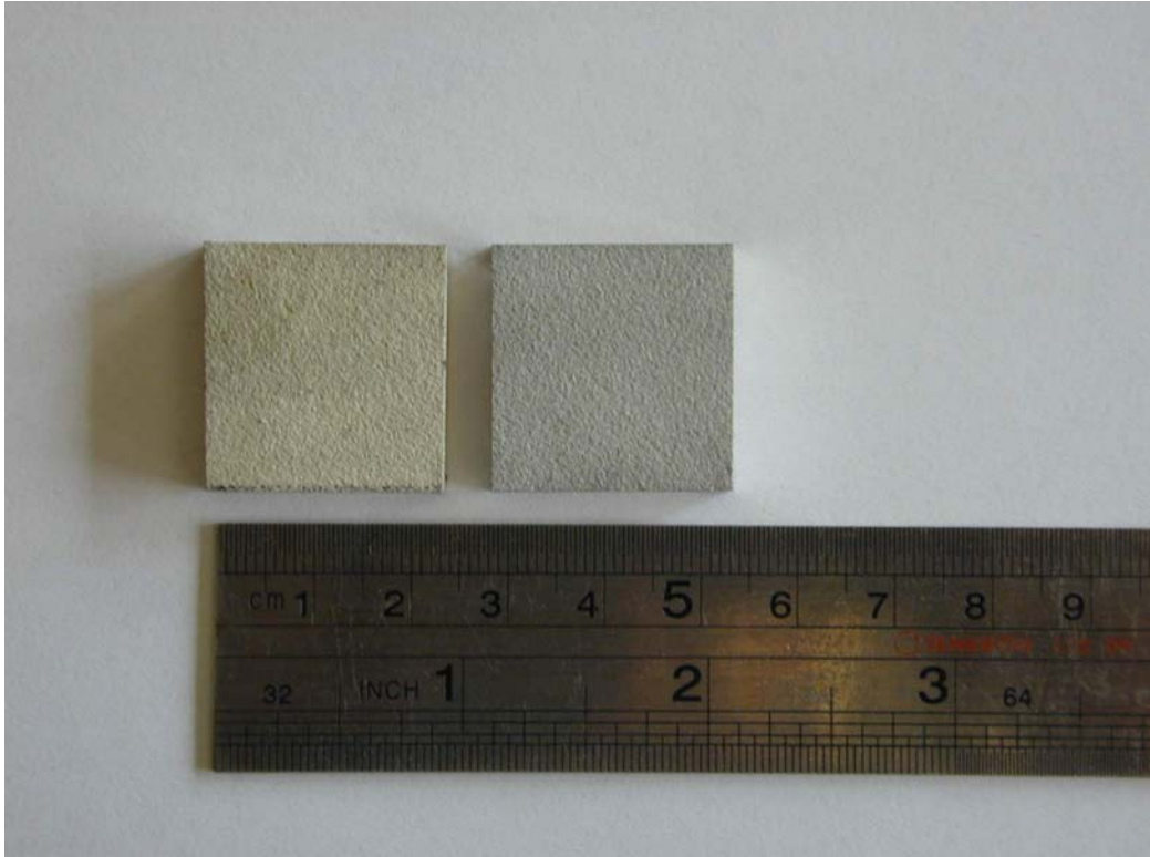
Şekil 3.9. Ön oksidasyon işlemi sonrası seramik kaplama yüzeyindeki renk deęişimi a) Uygulama öncesi, b) Uygulama sonrası.
