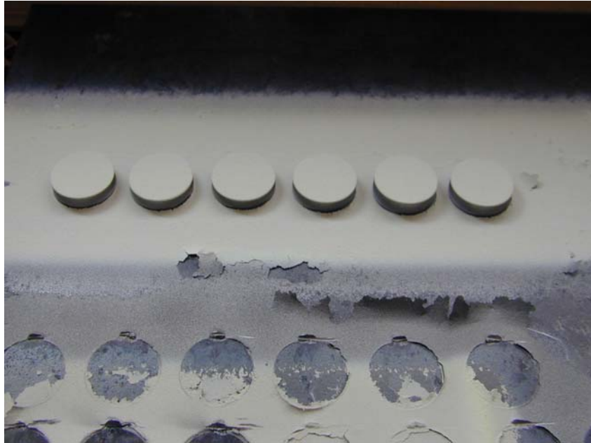
Şekil 3.1. TBK uygulanmış çekme test numuneleri.
