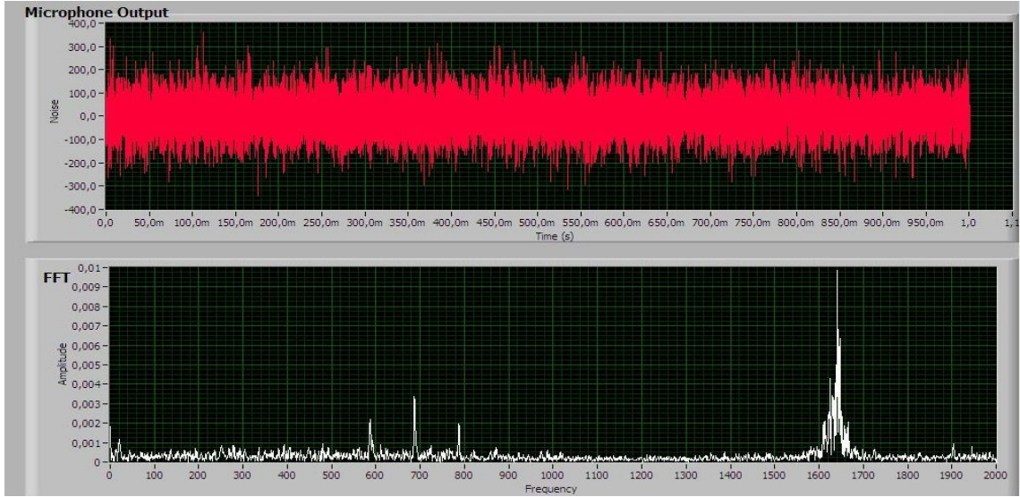
Şekil A.39. L=70 mm ( 20 \times 20 ) kesitli kater ve Al-7075 için ses testi ile tırlama frekansının belirlenmesi.
