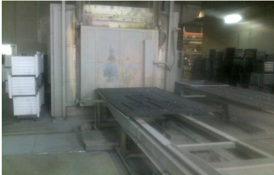
Şekil Ek 7. Kutu fırında ızgaranın emaye pişirimi
