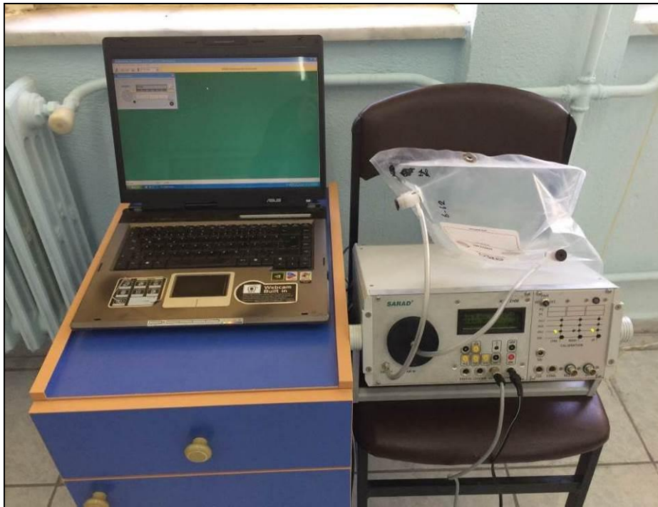
Şekil 5.9. GEO-RTM 2128 cihazından verilerin aktarılması.
