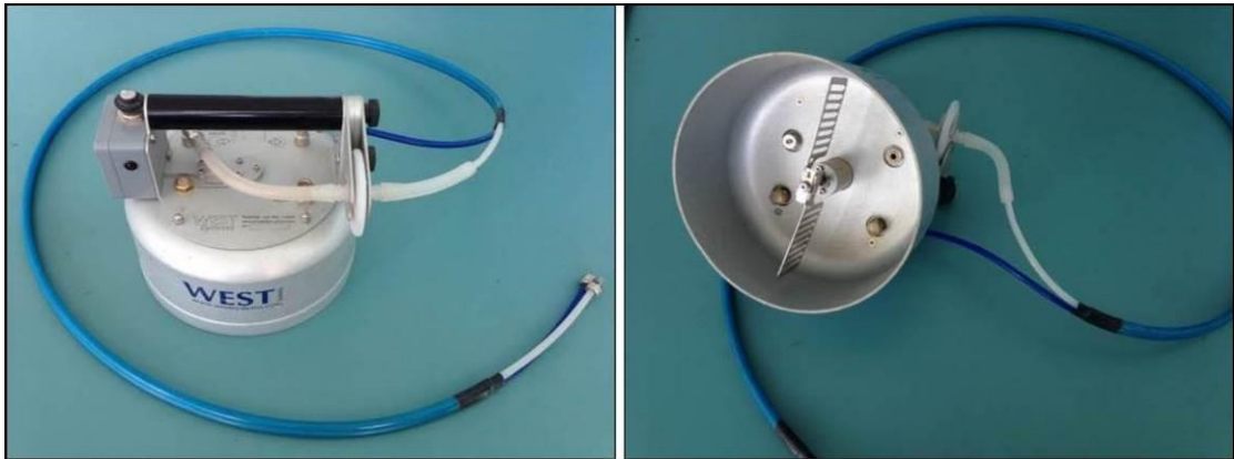
Şekil 5.12. CO 2 akış ölçümlerinde karbondioksiti toplamak için kullanılan ekipman.
