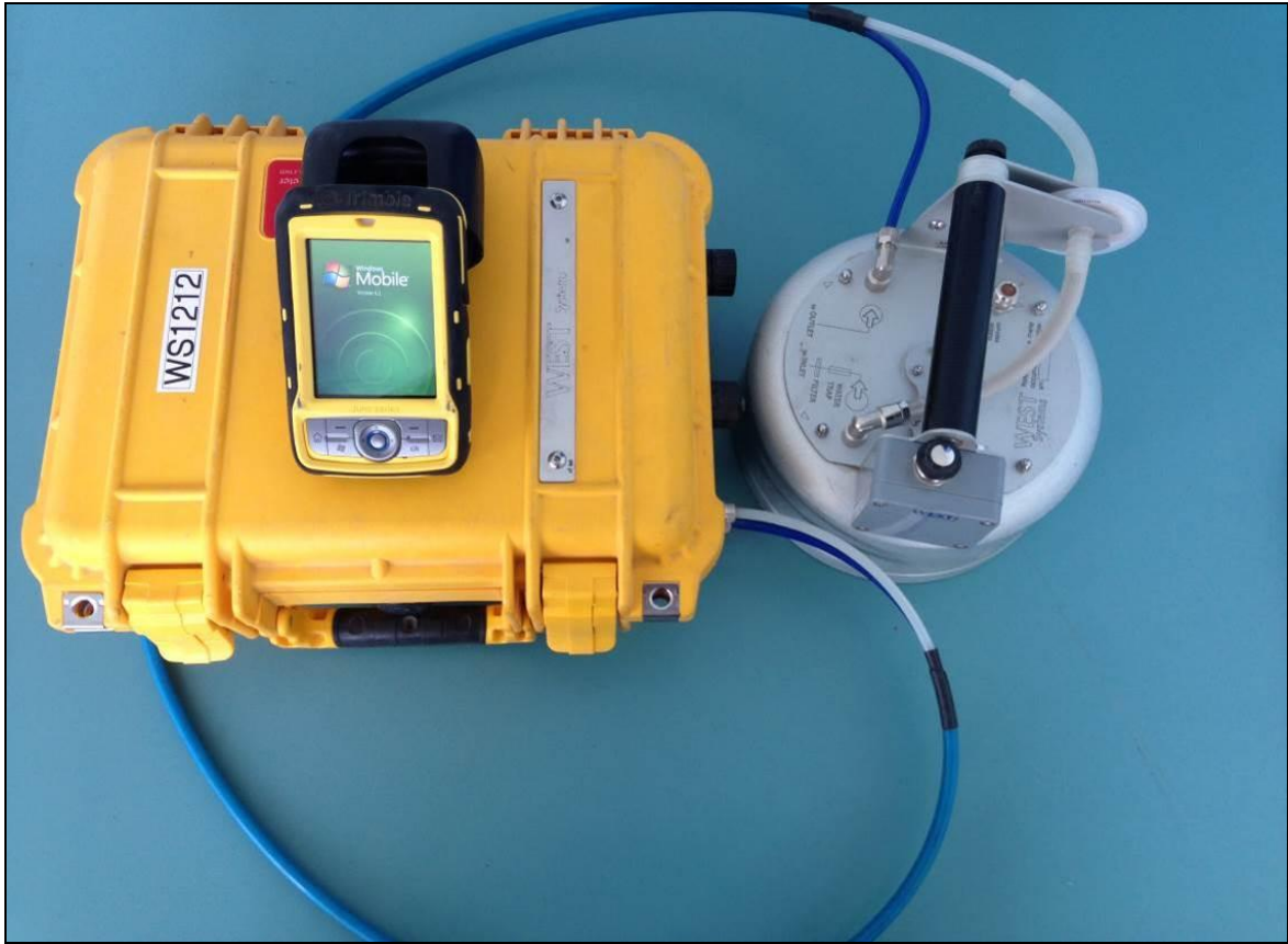
Şekil 5.2. CO 2 akış ve CO 2 konsantrasyon ölçüm cihazı.
