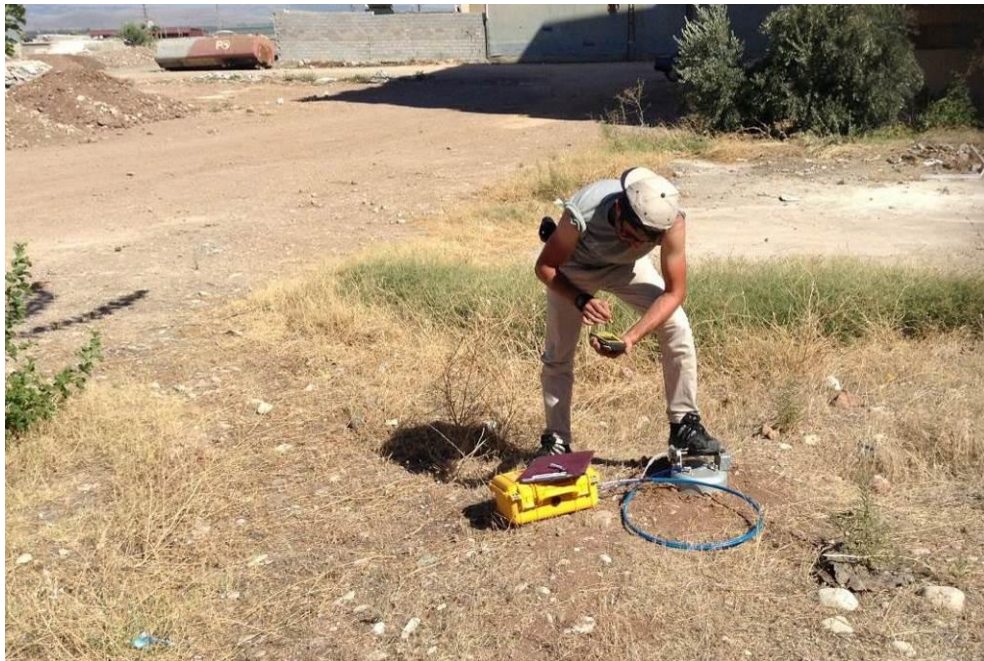
Şekil 5.10. Arazide CO 2 akış ölçümü yapılırken.
