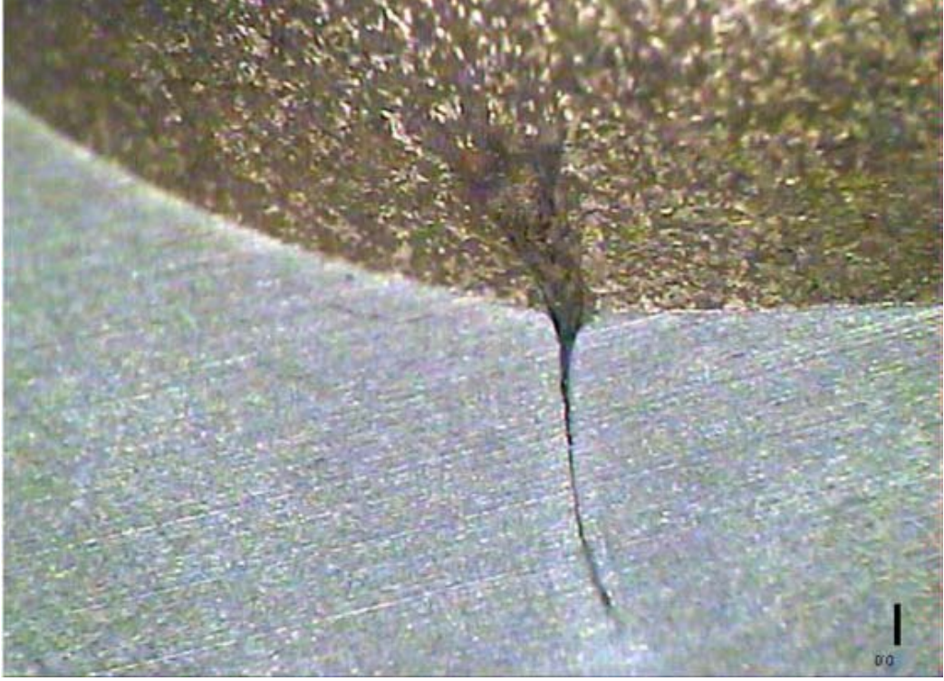
Şekil 2.40 Dövme parçada katlama hatası .
