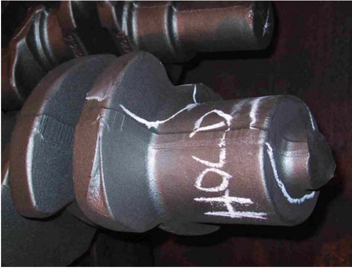
Şekil 2.13 Parçanın sert olması sebebiyle hurda edilmesi gereken krank . (Barret , 2004 )
