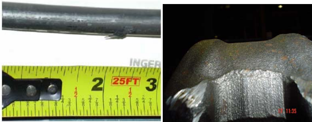
Şekil 2.34 Sıyırma sonrası oluşan saçak . ( Barret , 2004 )
