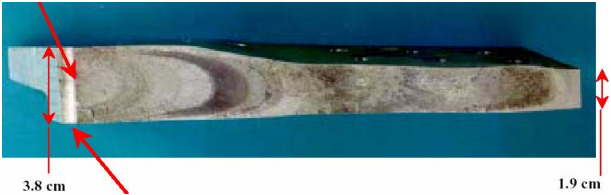
Şekil 2.52 Lif ( Chevron ) hatası sonucu ortaya çıkan kırılma izleri . ( Vural ve Özdöngül ve Sertkaya ve Alanyalı , 2004 )
