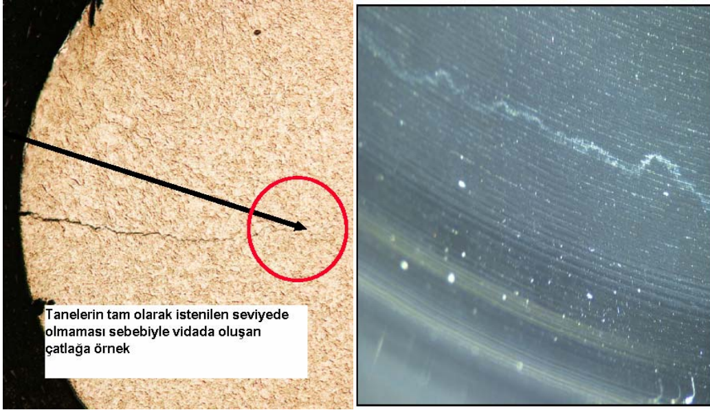
Şekil 2.20 Vidada oluşan çatlak ve stereo mikroskop görüntüsü . (American Society For Metals,1972 )
