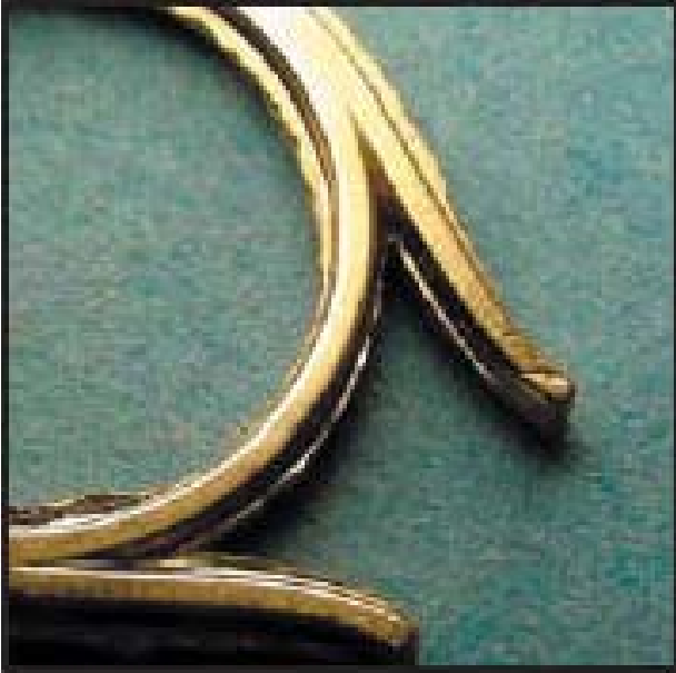
Şekil 2.30 Dövme işleminde oluşan apaklar .
