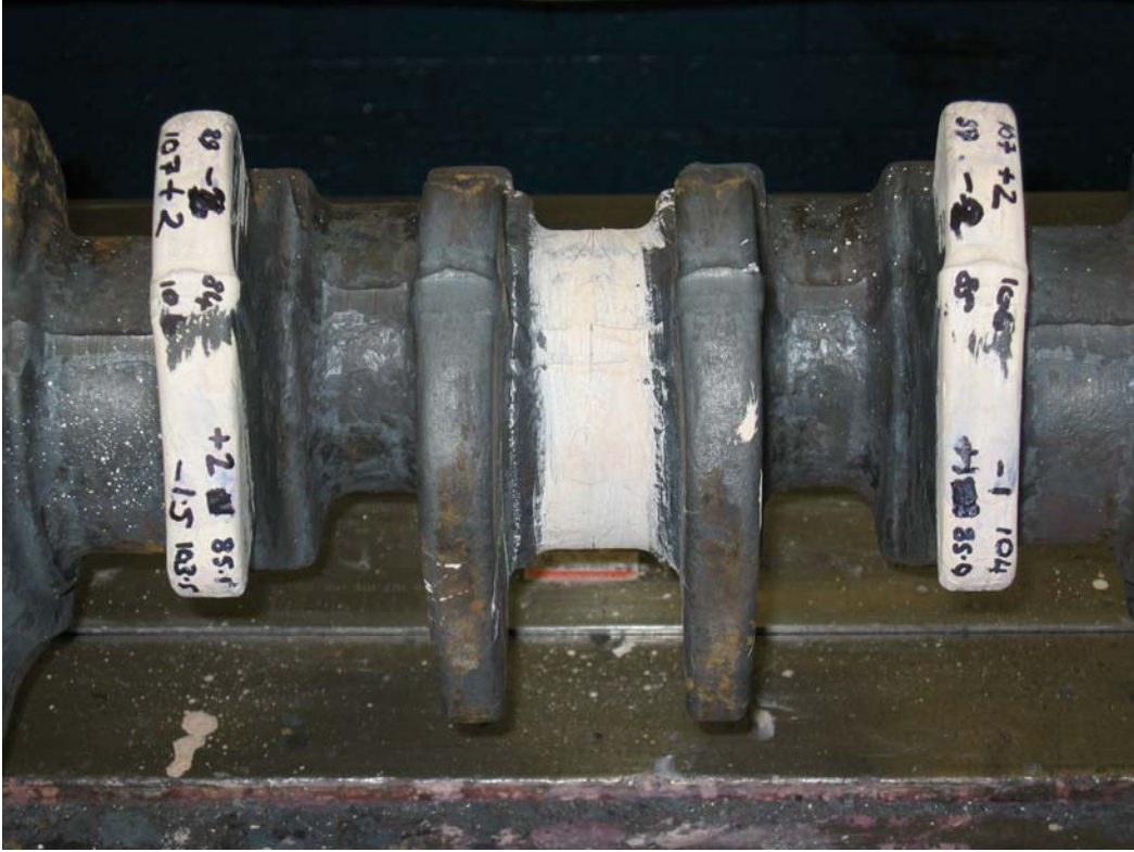
Şekil 2.28 Krankta kalıbın ekseninden dövme sırasında sapması sonucu pallerde oluşan kaçıklık . ( Barret , 2004 )
