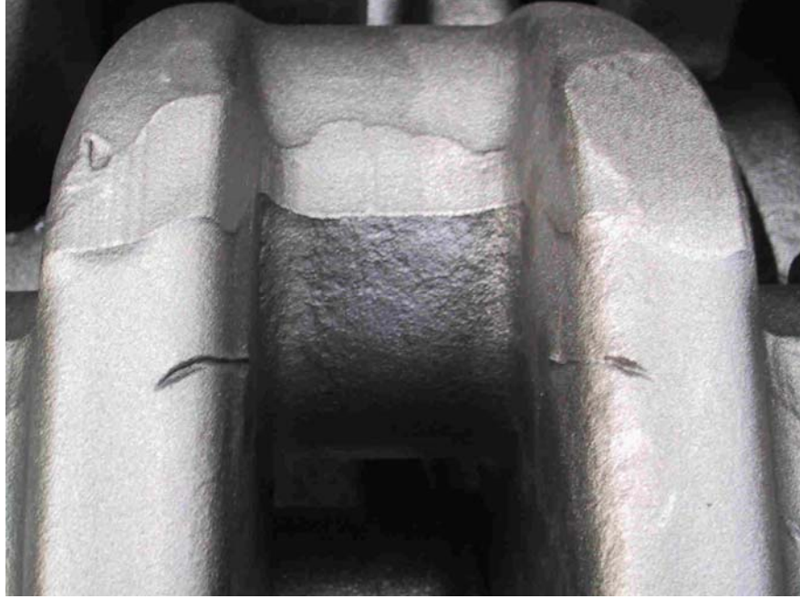
Şekil 2.36 Krankta batma hatası . ( Barret , 2004 )
