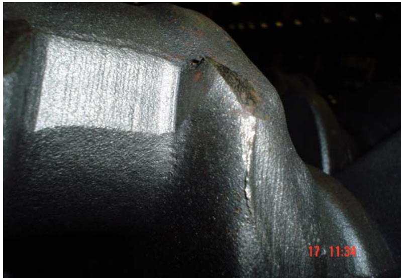
Şekil 2.32 Özellikle yuvarlak hatta sahip dövmelerde sıyırma hatası . ( Barret , 2004 )
