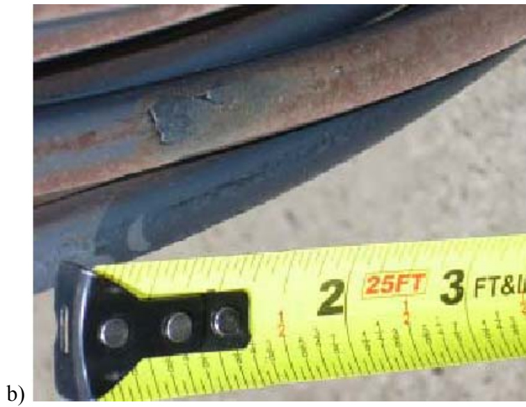
Şekil 2.15 Parçanın sert olması sebebiyle proses sırasında oluşan deformasyonlar .
