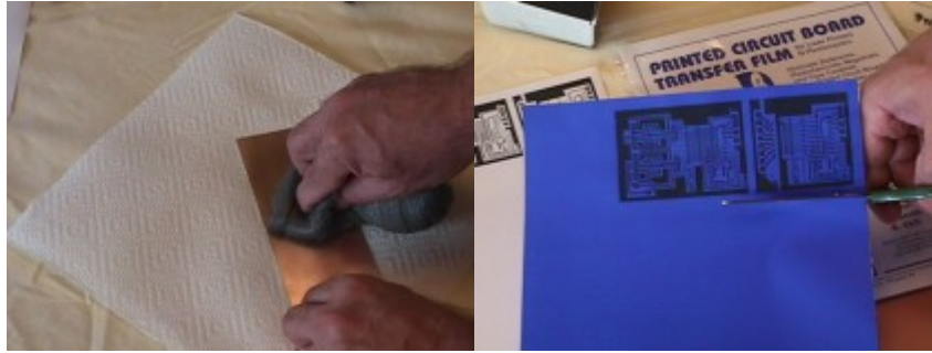
Şekil 4.2. Bakır plakanın temizlenmesi
