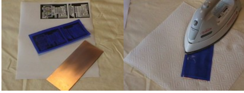
Şekil 4.3. Devrenin Ütü ile yapıştırılması
