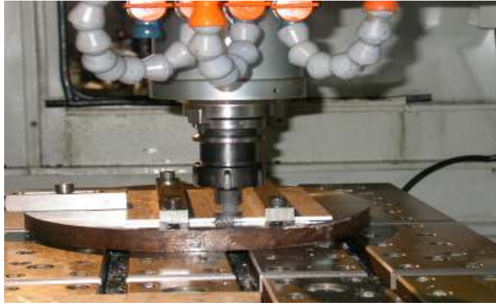
Şekil 5.3. Kaynak edilecek parçanın freze tezgahına bağlanış şekli
