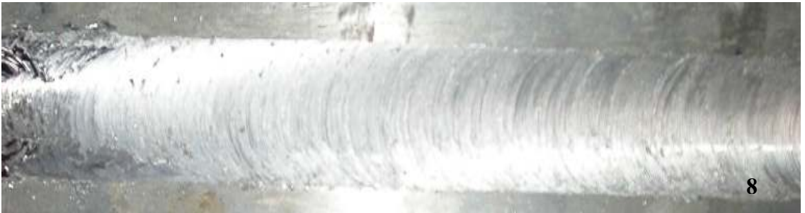
Şekil 6.2. Kaynak işlem parametrelerine bağlı olarak dikiş profilleri n:315 dev/dk, 5: V:25 mm/dk, 6: V:50 mm/dk, 7: V:100 mm/dk, 8: V:125 mm/dk
