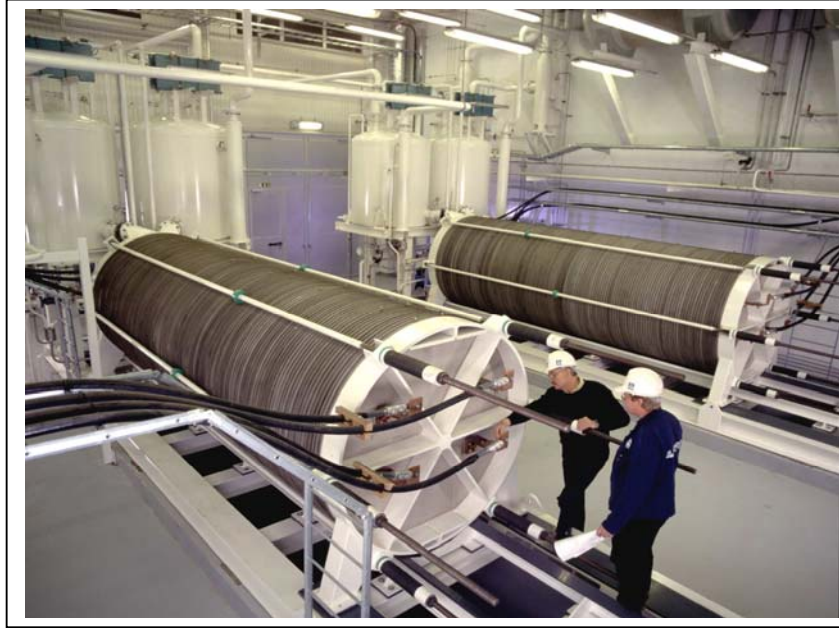
Şekil 4.5. Her Biri 2.000 kW Güce Sahip Norsk Hydro Alkalın Elektrolizörleri (Leighty, 2003)
