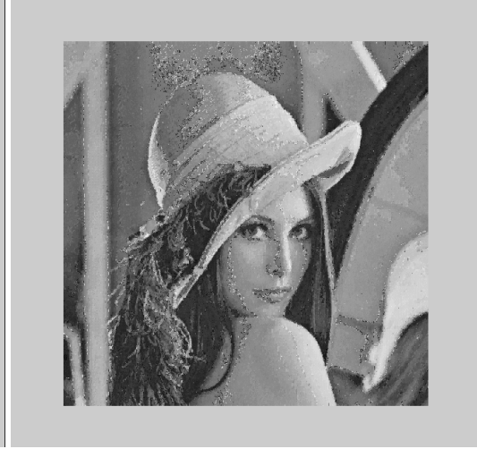
Şekil 5.21.f. 8 bit vektör kuantalamadan sonra elde edilmiş görüntü PSNR: 23.677
