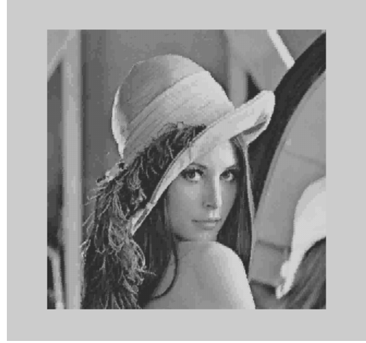
Şekil 5.6.d. Kod Kitabı: 256 1:64 ( 8 bit ) Sıkıştırma Oranı PSNR: 29.388
