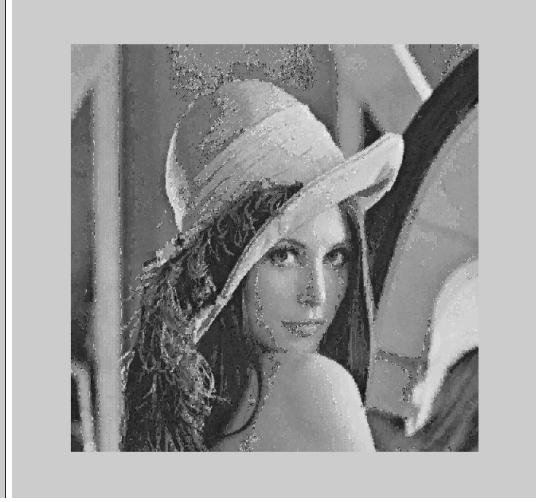
Şekil 5.19.f. 8 bit vektör kuantalamadan sonra elde edilmiş görüntü PSNR: 23.713
