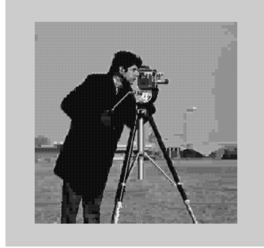
Şekil 5.7.f. Kod Kitabı: 1024 1:4 ( 8 bit ) Sıkıştırma Oranı PSNR: 24.965
