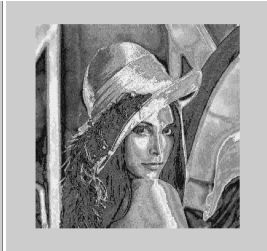
Şekil 5.21.d. Kod Kitabı:1024 1:16 ( 4 bit ) Sıkıştırma Oranı PSNR: 46.539
