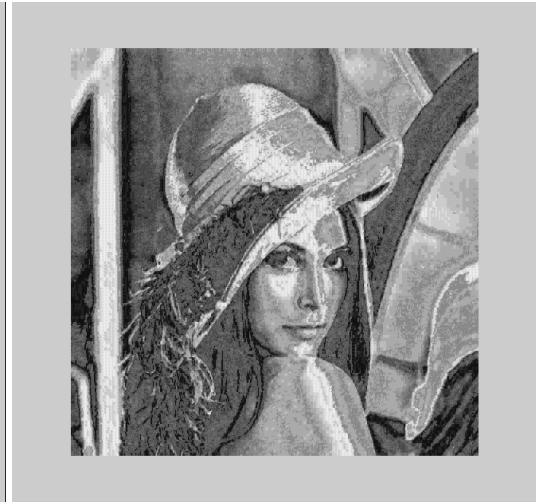
Şekil 5.19.b. Kod Kitabı: 512 MSB için kullandığımız kod kitabı kullanarak 1:32 ( 4 bit ) Sıkıştırma Oranı PSNR: 41.673
