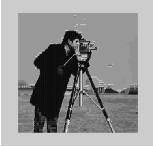
Şekil 5.7.e. Kod Kitabı: 512 1: 8 ( 8 bit ) Sıkıştırma Oranı PSNR: 22.958
