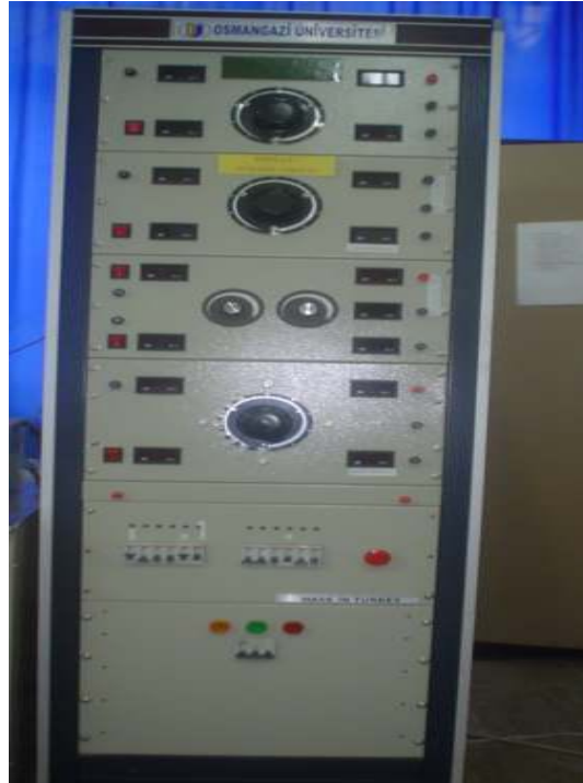
Şekil 4.7 TVA sisteminin güç kaynağı.
