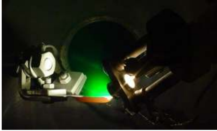
Şekil 5.1 Gümüş materyalinin TVA sistemiyle oluşturulan plazma hali.
