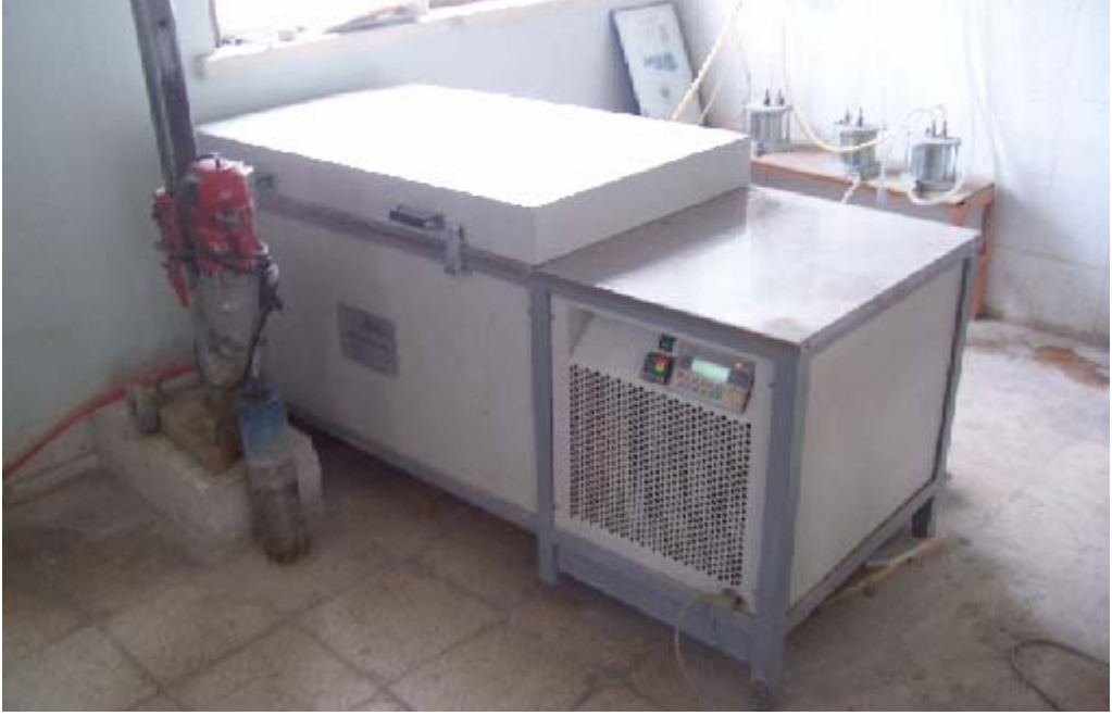
Şekil 7.7. Dona dayanım deneylerinin yapıldığı dondurma – çözme dolabı
