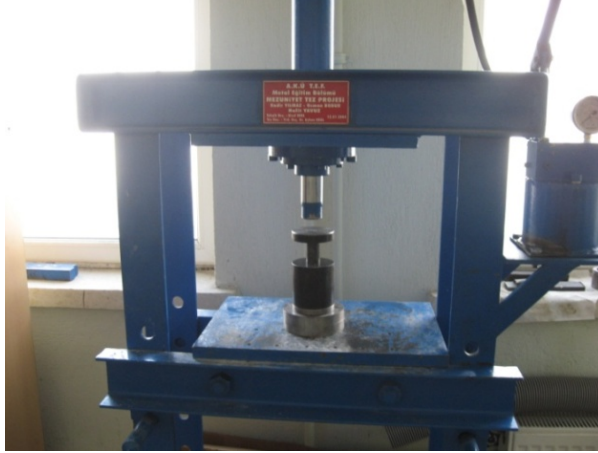
Şekil 7.5. Şekillendirme işleminde kullanılan hidrolik pres ve kalıp.
