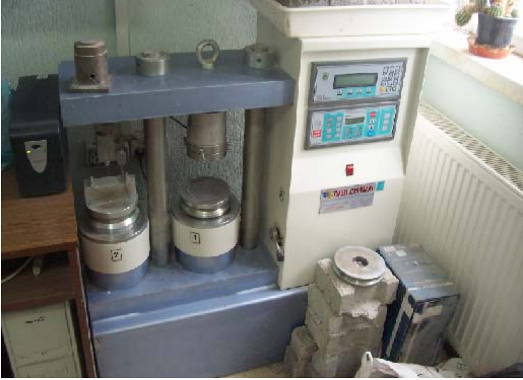
Şekil 7.8. 3 nokta eğme mukavemeti testlerinin yapıldığı pres
