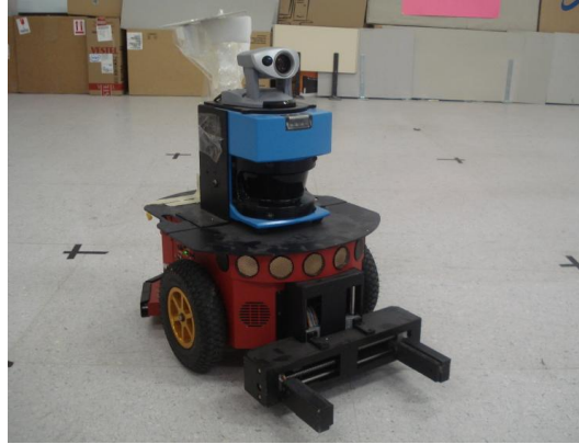
Şekil 6. 3 Pioneer P3-DX diferansiyel sürüslü holonomik olmayan ve çatal kaldırıcıya sahip gezgin robot
