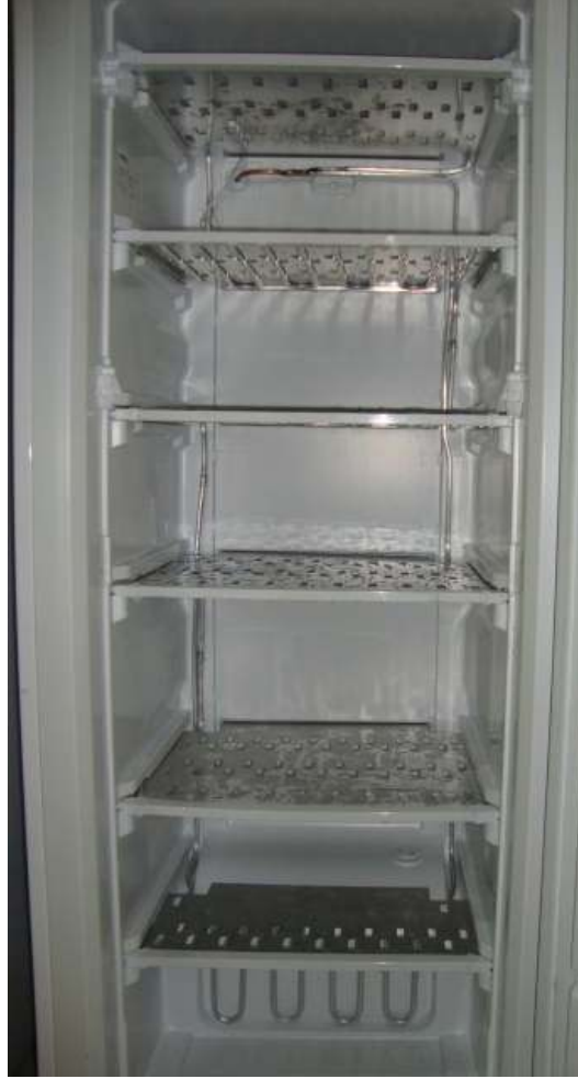
Şekil 5.2 Derin dondurucu kabini ve plaka borulu (TOS) buharlaştırıcı
