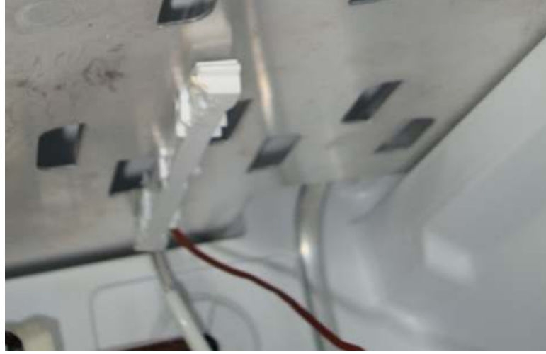
Şekil 5.3 Derin dondurucuda kullanılan termostat bulbu'nun yerleşimi
