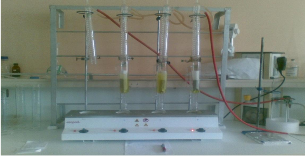
Şekil 2.6. Bitkisel materyalin sokslet cihazında petrol eteri ile ekstraksiyonu
