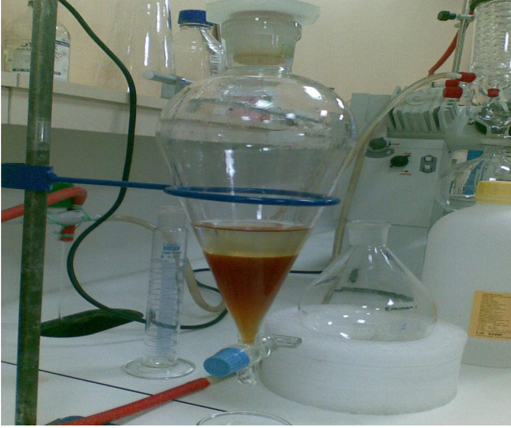
Şekil 2.9. Ayırma hunisinde etil asetat ile sulu fazın ayrılması (Özüt C eldesi)
