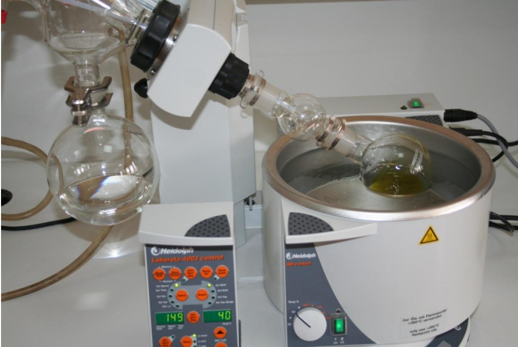
Şekil 2.7. Çözücünün rotary evaporatörde (döner buharlaştırıcı) vakum eşliğinde uzaklaştırılması
