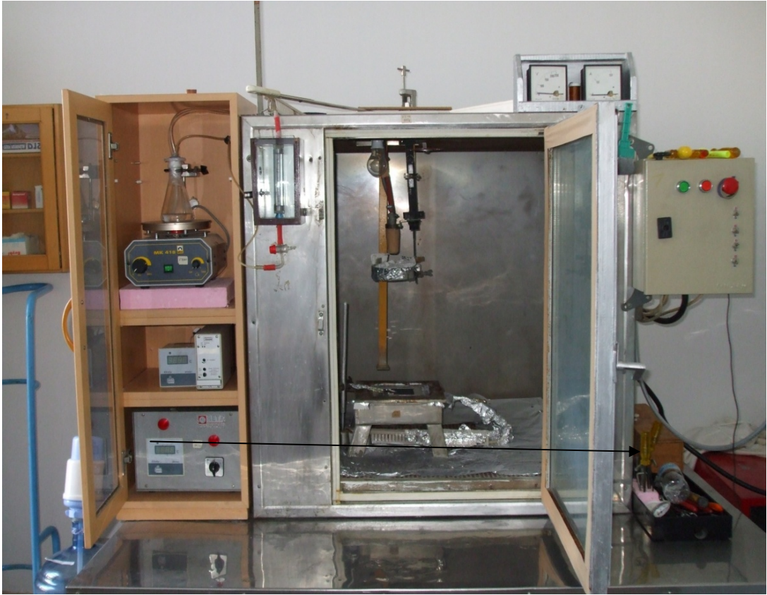
Şekil 2.3. Ultrasonik kimyasal püskürtme yönteminde kullanılan sistemin fotoğrafı (Eskişehir Osmangazi Üniversitesi Araştırma Laboratuvarı)
