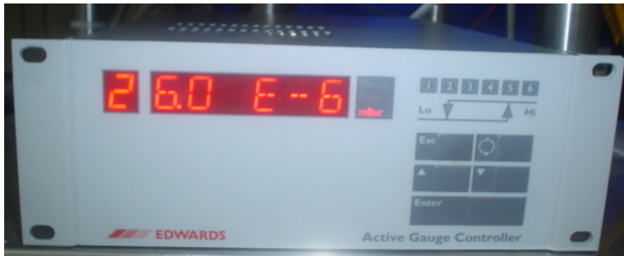
Şekil 4.3 TVA sisteminin dijital 3 girişli basınçölçer monitörü.
