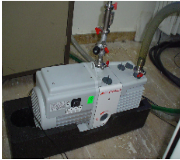
Şekil 4.4 TVA sisteminin mekanik pompası.
