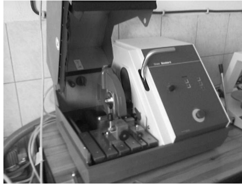
Şekil 6.6. Struers Discotom-5 numune kesme cihazı.
