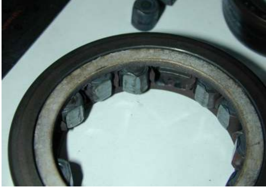
řekil 4.2: Düşük Yađ Tazyik Sonucu Oluřan Yatak Hasarı
