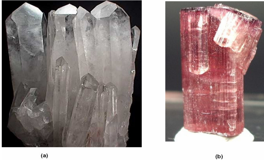
Şekil 2.12 Piezoelektirik olayda en çok kullanılan kristaller,(a) Kuartz kristalinin resmi ( http://www.rockhounds.com/rockshop/quartz11.jpg ) (b) Turmalin kristalinin resmi ( http://www.kcminerals.com/tourmaline.htm ).
