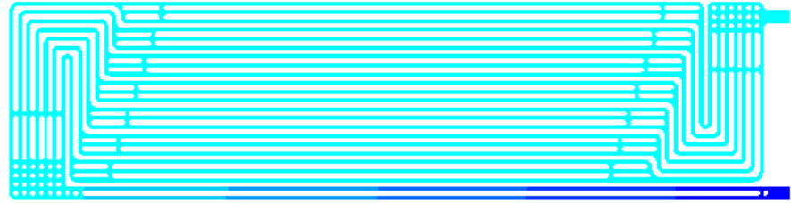
Şekil 5.12 2 numaralı buharlaştırıcı için buhar fazında R134a soğutkanının hız dağılımı [m/s]
