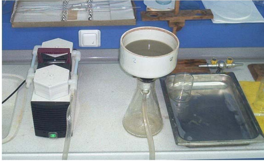
Şekil 5.7. Cevherden altın özütlemesinde liç sonrası süzme düzeneği.
