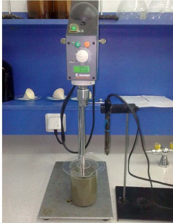
Şekil 5.6. Cevherden altın özütlenmesinde liç deneyi düzeneği.
